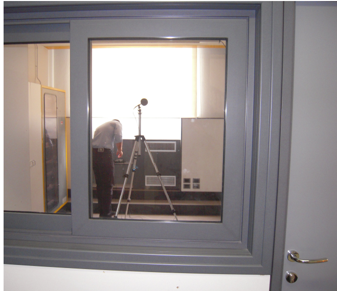
Figura 58 - Foto da rilievo svolto: operatore con fonometro pronto al rilievo a scansione manuale
