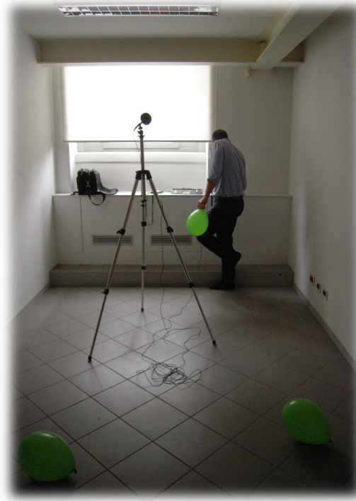
Figura 59 - Foto del rilievo svolto, operatore pronto al rilievo del tempo di riverbero
