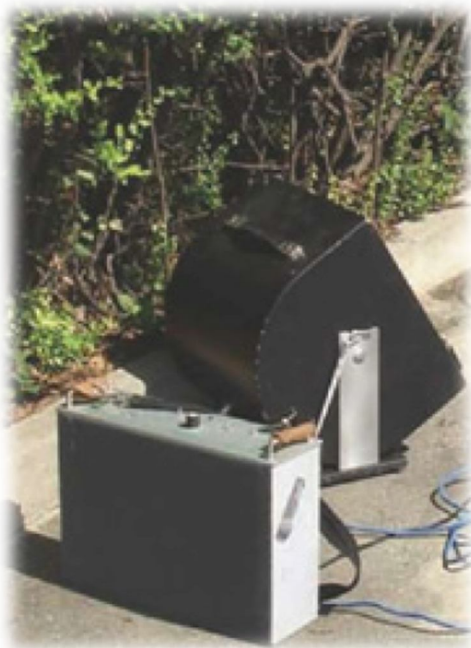
Figura 40 - Generatore a cassa monodirezionale
