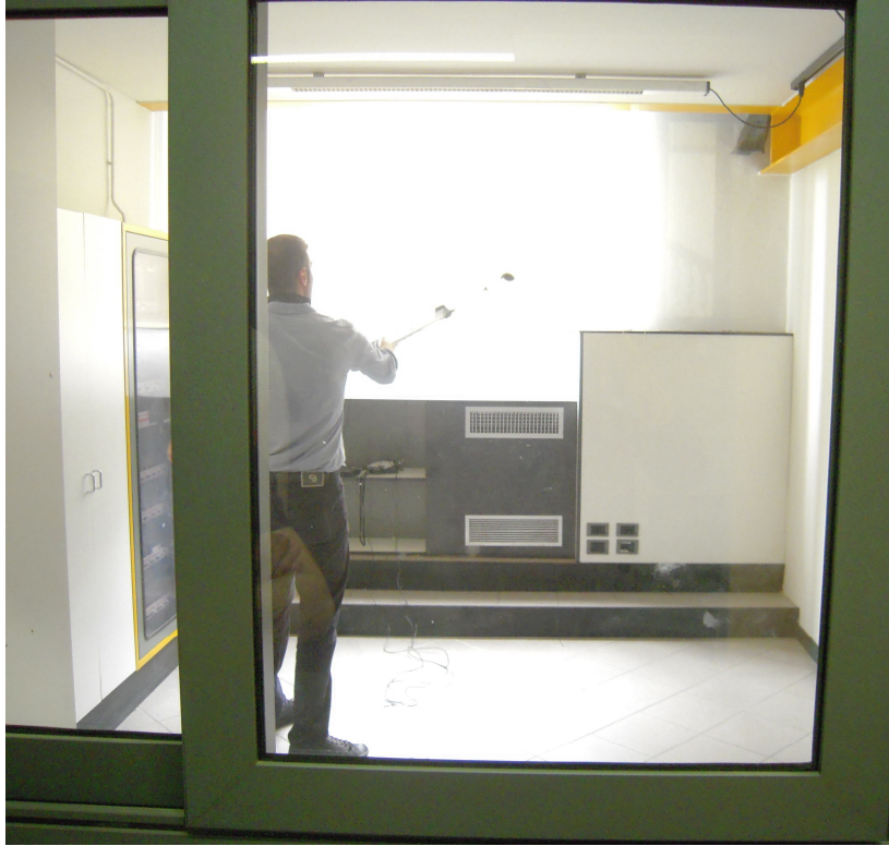
Figura 61 - Foto del rilievo svolto, percorso a scansione manuale svolto dall'operatore
