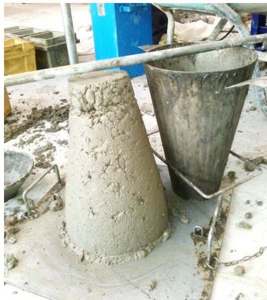
Figura G.9 Prova di abbassamento al cono di Abrams con risultato 1,5 cm
