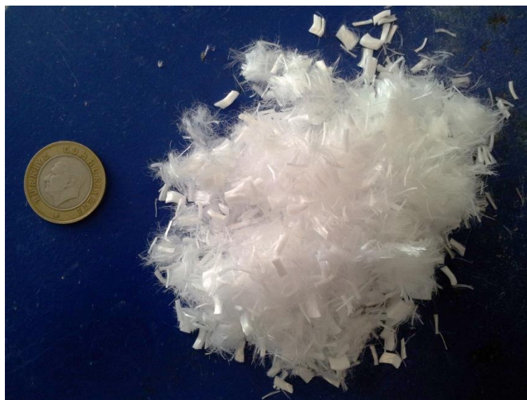
Figura 3.10 Fibre in polipropilene fibrillato di 6 mm
