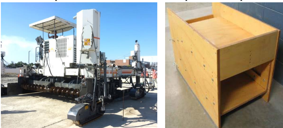
Figura 4.1 Slip-form in dimensioni reali (a sinistra), mini slip-form da precedenti ricerche (a destra).
