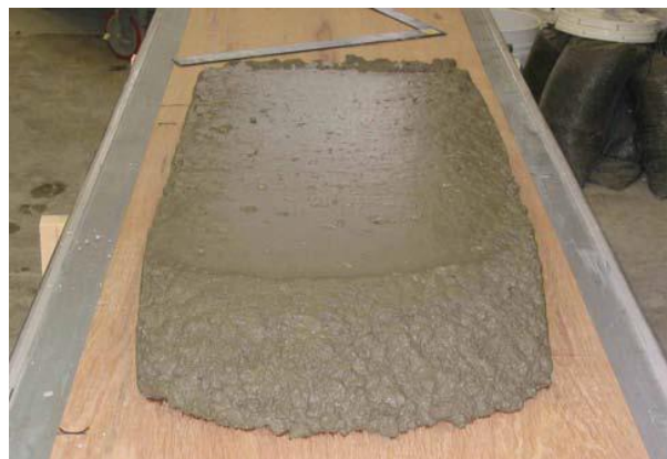
Figura 2.25 Prova di un calcestruzzo auto-compattante attraverso mini slip-form.
