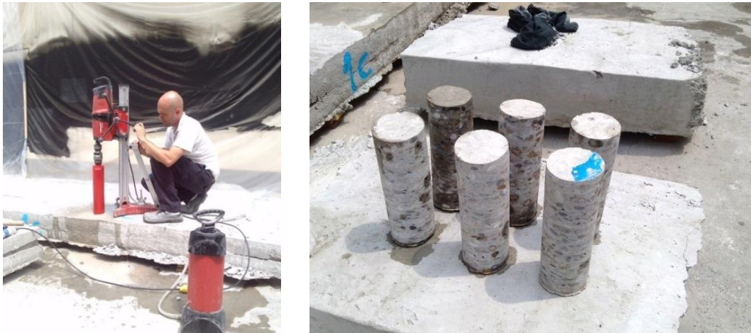
Figura 5.16 Carotatura delle lastre di calcestruzzo
