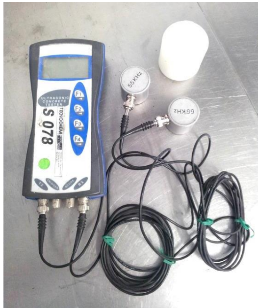
Figura 5.9 Apparecchiatura per le prove ultrasoniche.
