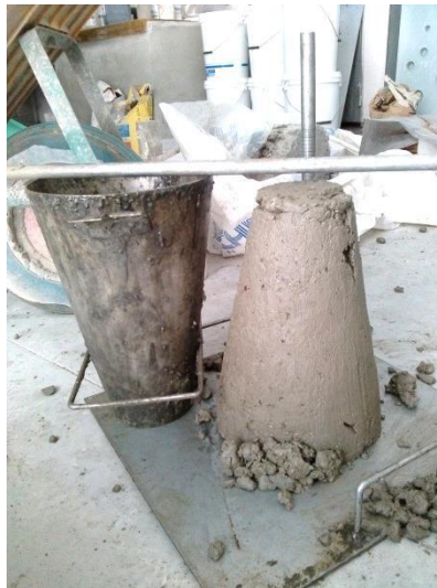
Figura 5.2 Prova di consistenza mediante abbassamento al cono di Abrams secondo UNI EN 12350-2.
