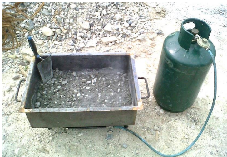
Figura 5.6 Determinazione del contenuto d'acqua mediante bruciatura secondo UNI 11201.
