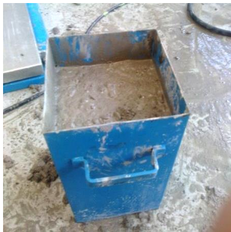
Figura 5.4 Prova di compattabilità secondo UNI EN 12350-4.
