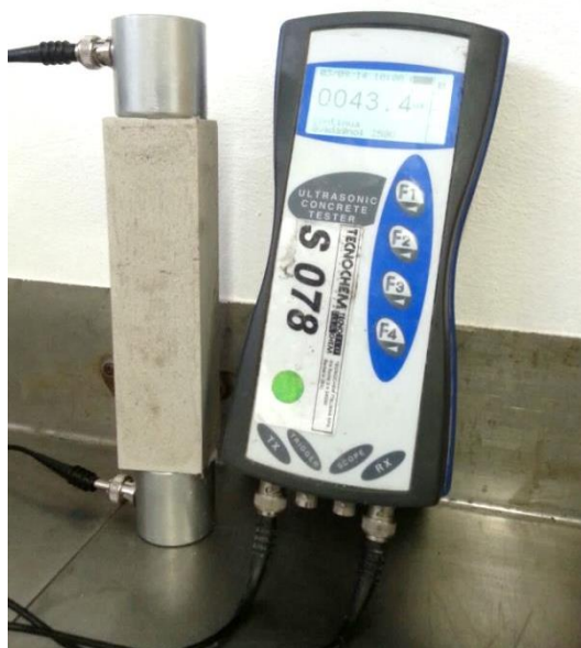
Figura 5.12 Misura ultrasonica su travetti.
