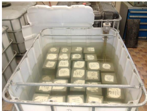
Figura 5.8 Maturazione dei provini in acqua secondo UNI EN 12390-2
