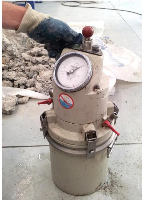
Figura 5.5 Apparecchiatura per la misura del contenuto d'aria
