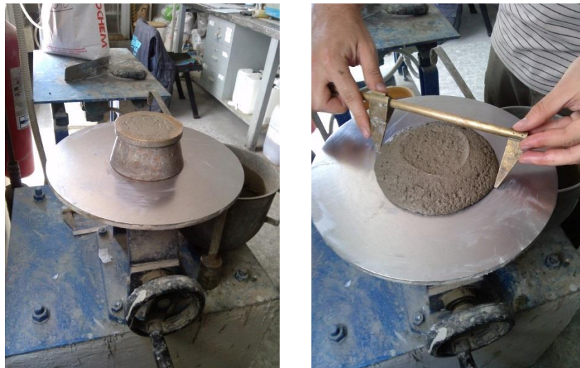
Figura 5.13 Prova di spandimento delle malte secondo UNI EN 1015-3.
