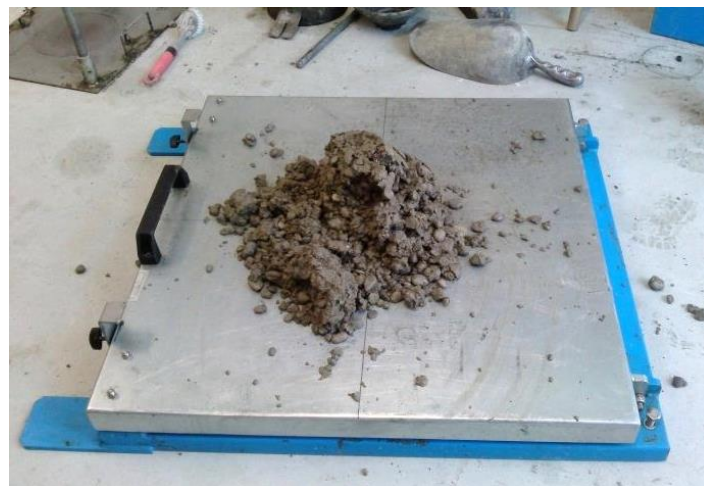
Figura 6.1 Prova di spandimento su tavola a scosse non classificabile.
