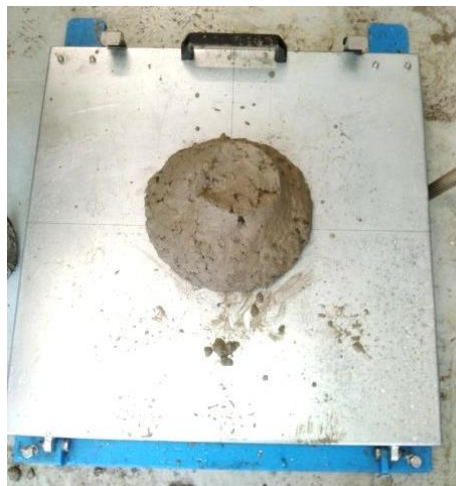
Figura 5.3 Prova di spandimento su tavola a scosse secondo UNI EN 12350-5.
