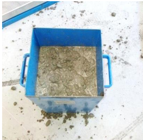
Figura G.11 Indice di compattabilità con risultato 1,23
