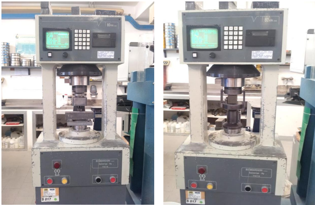
Figura 5.11 Pressa configurata per la rottura a flessione (sinistra) e a compressione (destra).
