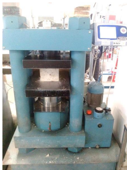
Figura 5.7 Prova di resistenza a compressione su cubi secondo UNI EN 12390-4.
