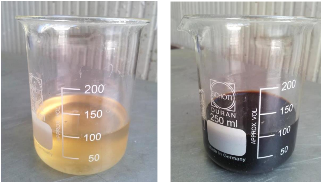
Figura 3.9 Additivo superfluidificante (a sinistra) e additivo aerante (a destra)
