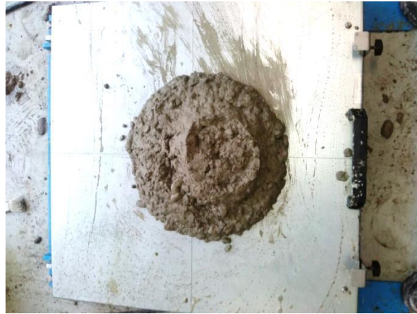
Figura G.10 Prova di spandimento su tavola a scosse con risultato 27,5 cm
