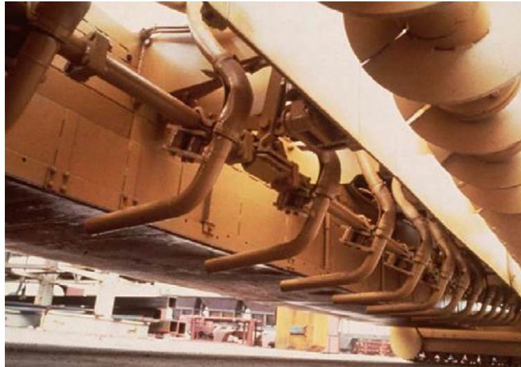
Figura 2.11 Foto dal sotto dei vibratori di una slip-form (ACPA).
