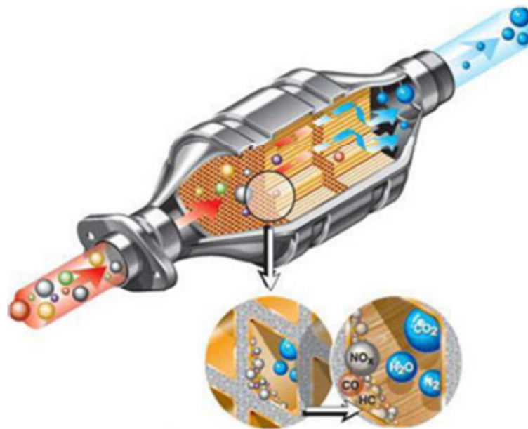
Figura I.7: Schema di una marmitta catalitica con catalizzatore a tre vie
