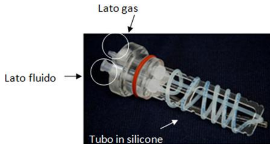
Figura 3.4 Fotografia del deossigenatore. Come è possibile osservare, il deossigenatore è composto dal tappo avente due accessi per il lato gas e due accessi per il lato fluido. Il mezzo di coltura viene fatto fluire all'interno del tubo in silicone attraverso il quale si realizza lo scambio gassoso. Adattato da [59, 61]
