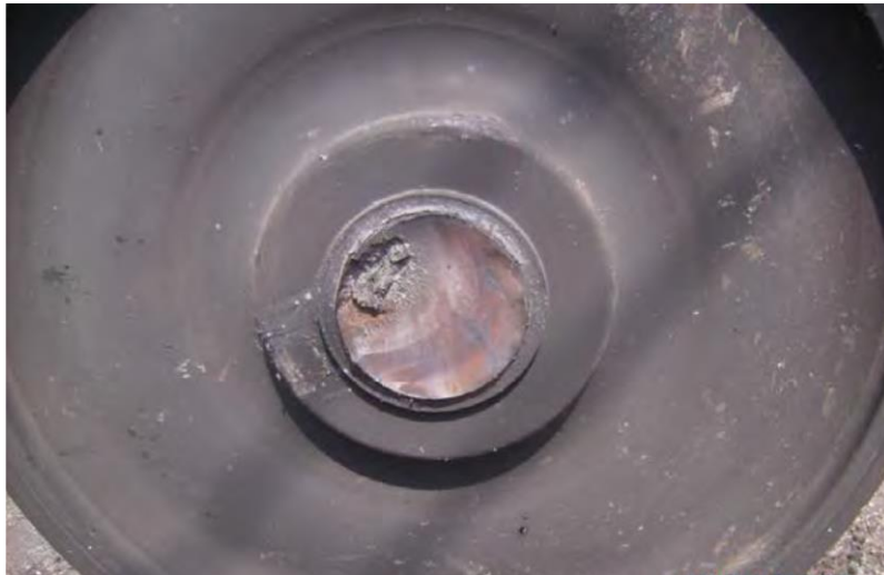
Figura 2.2: Cricca in un assile ferroviario.
