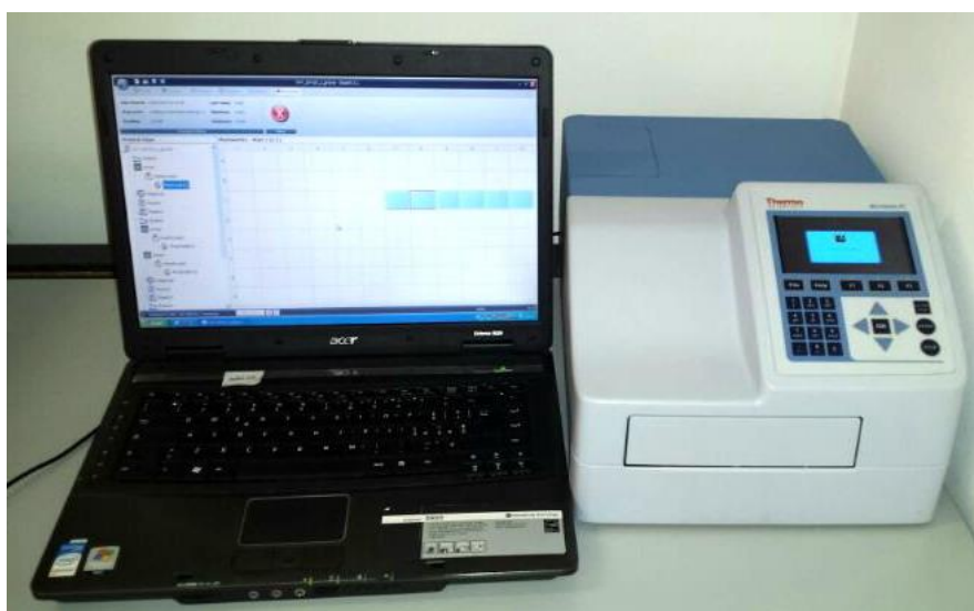
Figura 3.14: Sistema di lettura spettrofotometrica: lo spettrofotometro è collegato ad un computer che tramite software permette di effettuare le misurazioni di assorbanza dei campioni piastrinici.
