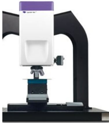
Figura 28- Fotografia del profilometro olografico digitale utilizzato [6]
