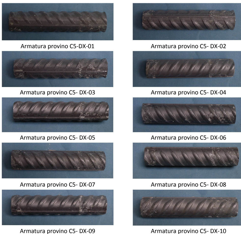
Figura 3.28 Armature estratte dai provini di calcestruzzo con 5% di cloruri ( \text{CaCl}_2 ) in massa rispetto al cemento al termine delle prove di polarizzazione potenziostatica anodica a +200 \text{ mV/SCE} ( T = 23^\circ\text{C} ).
