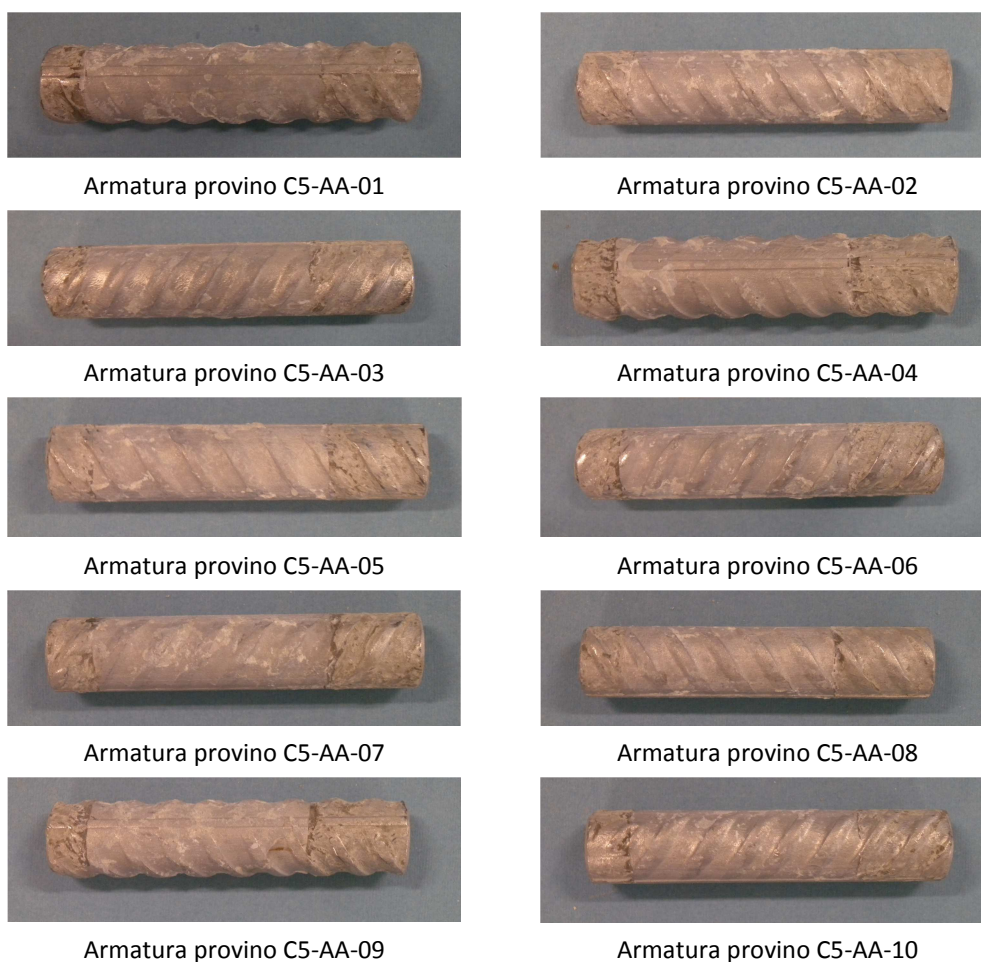
Figura 3.17 Armature estratte dai provini di calcestruzzo con 5% di cloruri ( \text{CaCl}_2 ) in massa rispetto al cemento al termine delle prove di polarizzazione potenziostatica anodica a +200 mV/SCE ( T = 23^\circ\text{C} ).
