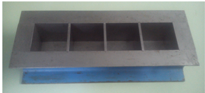
Figura 2.8 Cassaforma per ottenere provini cubici non armati per la prova di resistenza a compressione
