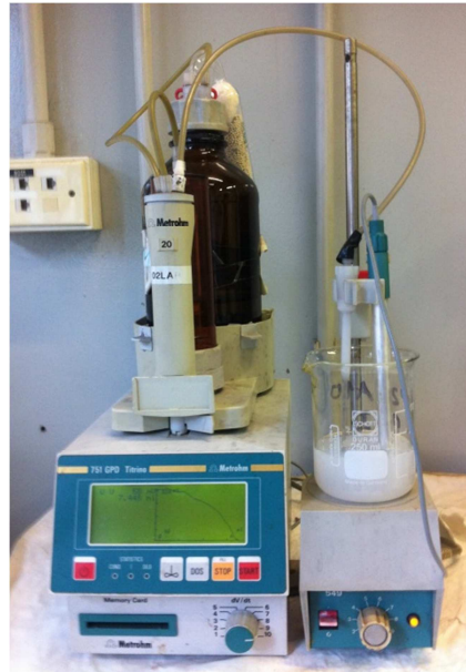
Figura 2.11 Titolatore con un beaker in cui è disciolta la polvere di calcestruzzo
