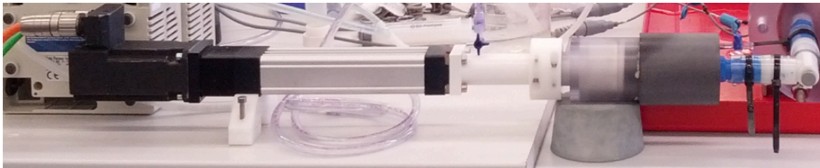
Figura 2.30 - Pompa a pistone utilizzata come sistema pulsatile nel setup TU/e.
