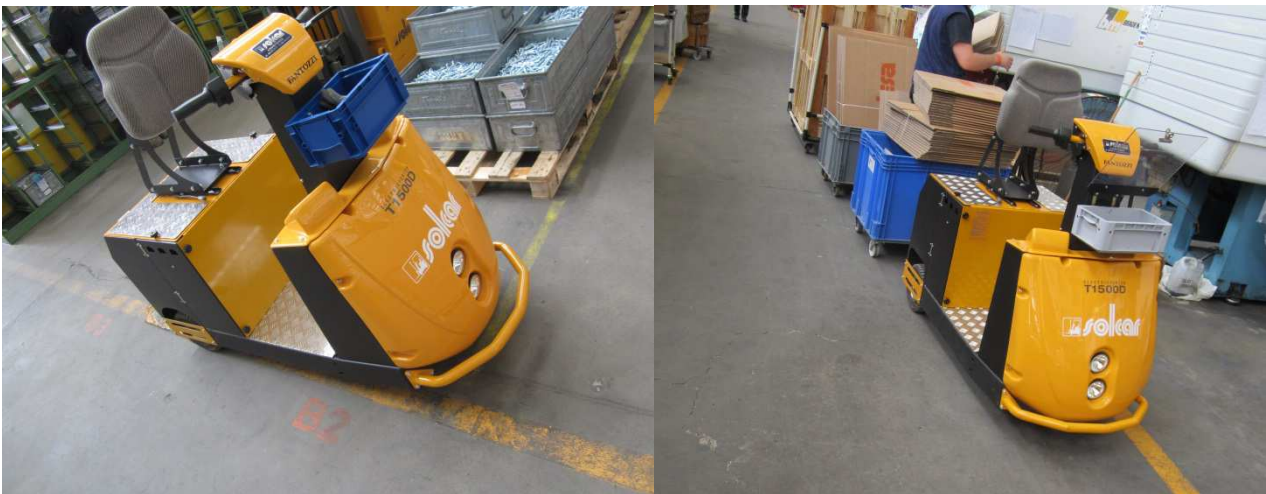
Figura 2.16 "Vespetta" locomotrice e treno di approvvigionamento
