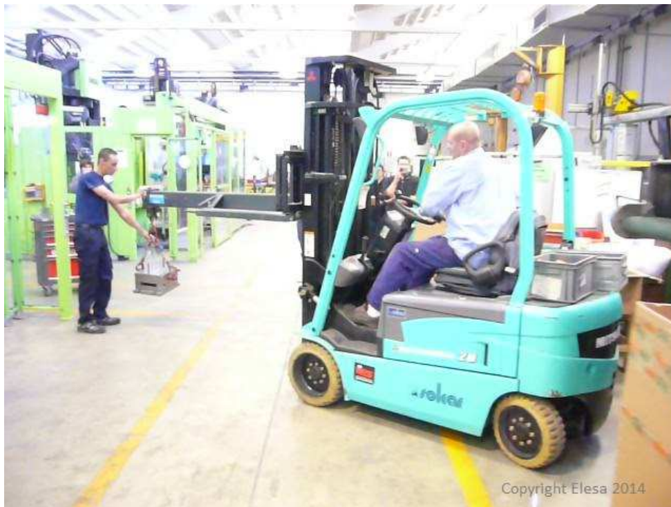
Figura 2.8 Trasporto di una parte di un incastellatura di uno stampo.
