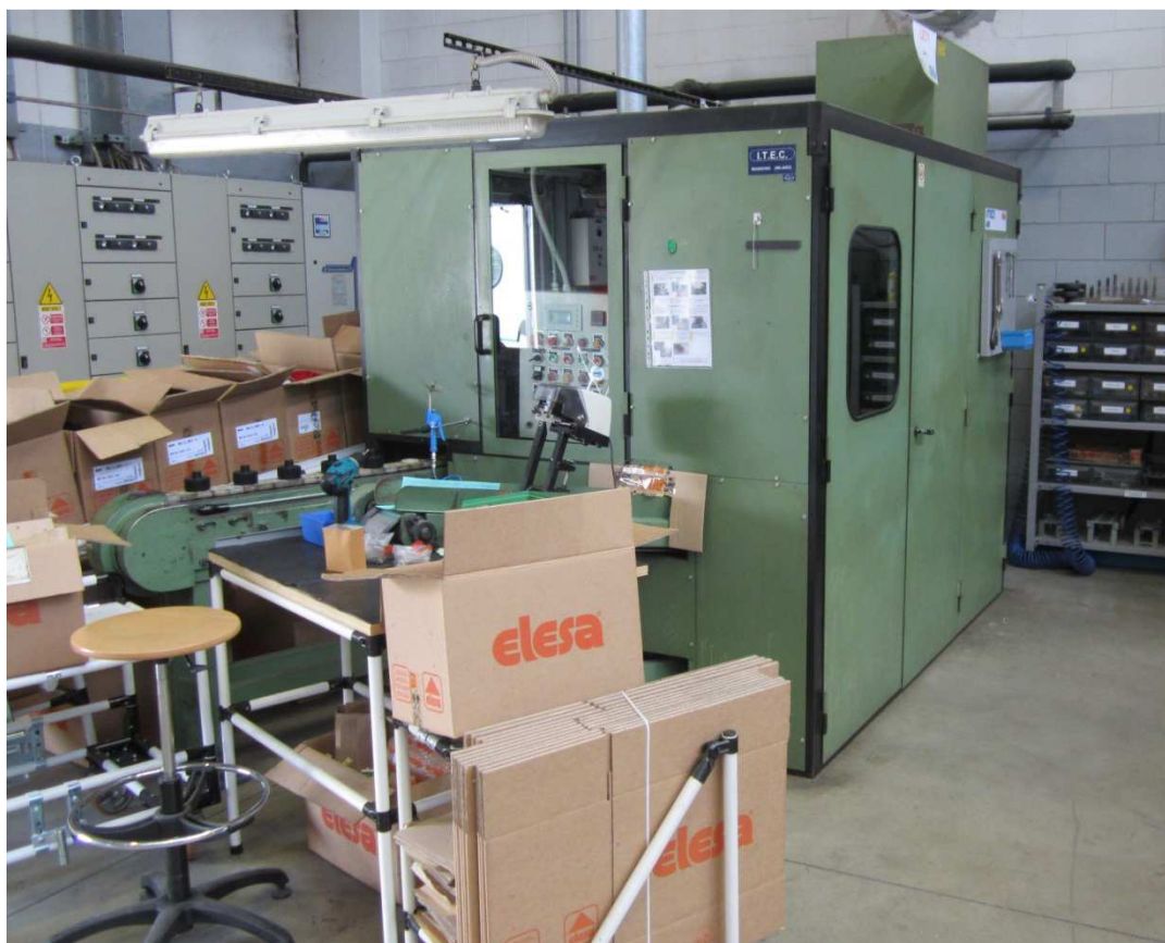
Figura 3.5 Macchina per la realizzazione della zigrinatura usata oggi solo per alcuni speciali.
