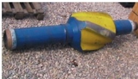
Figura 3.5: Stabilizzatore Fonte: Enciclopedia degli idrocarburi
