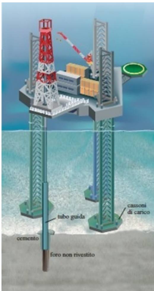
Figura 3.14: Piattaforme di perforazione autosollevanti Fonte: Enciclopedia degli idrocarburi
