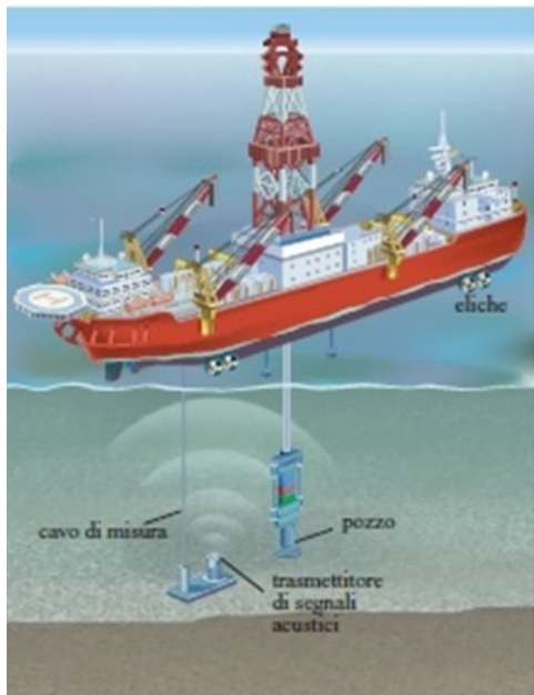
Figura 3.16: Navi di perforazione Fonte: Enciclopedia degli idrocarburi
