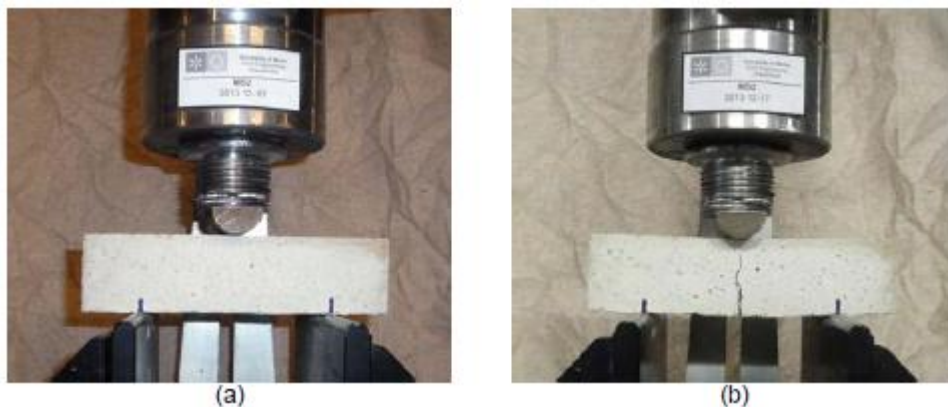
Figura 2-4 – Prova a flessione a) provino integro; b) provino rotto
