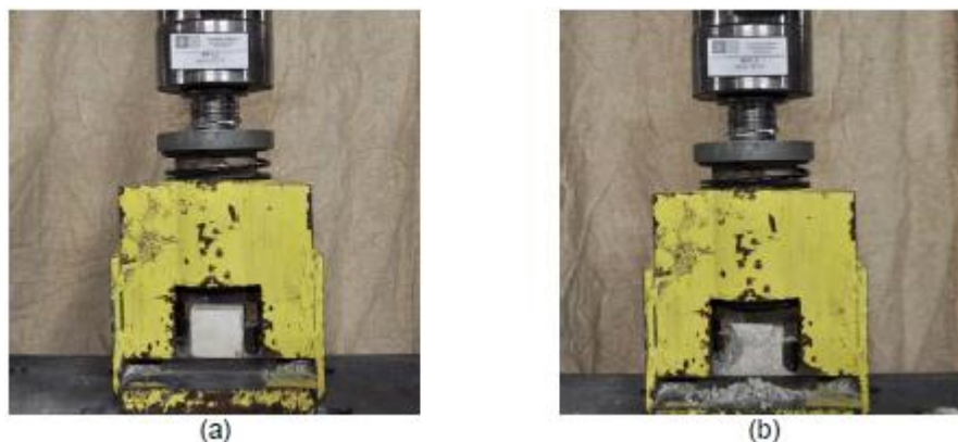
Figura 2-5- Prova a compressione a) provino integro; b) provino rotto
