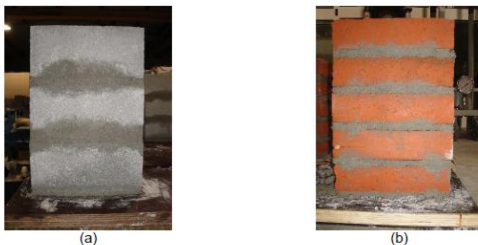
Figura 2-1- Configurazione finale dei provini: a) pannello con blocchi forati in calcestruzzo; b) pannello in mattoni
