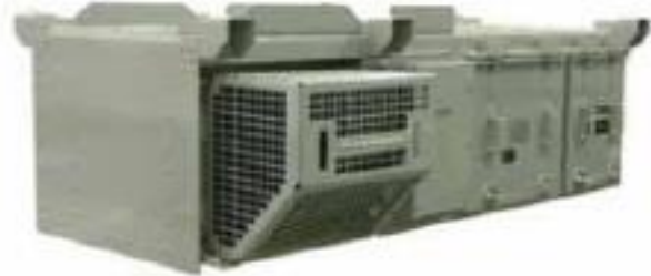
Figura 5-6 Automotrice utilizzata nella linea Ginza di Tokyo (a sinistra) e sistema di alimentazione ausiliario per automotrici (destra)
