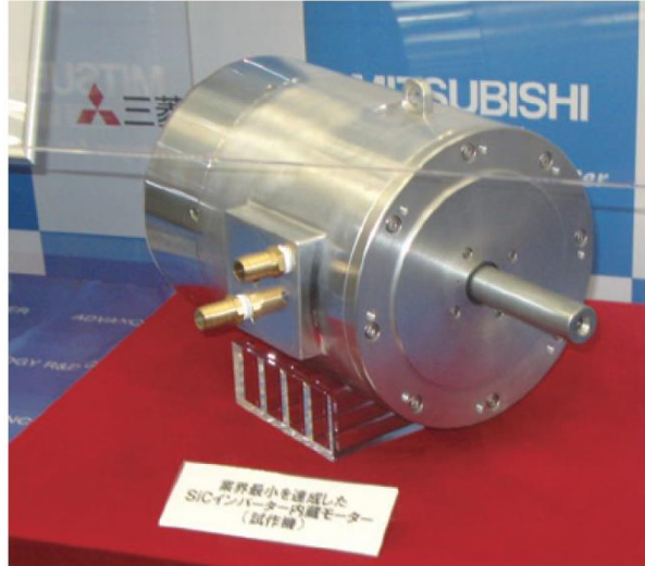
Figura 5-2 Struttura di un motore elettrico Mitsubishi che integra al suo interno l'inverter; la potenza complessiva del dispositivo è di 70kW
