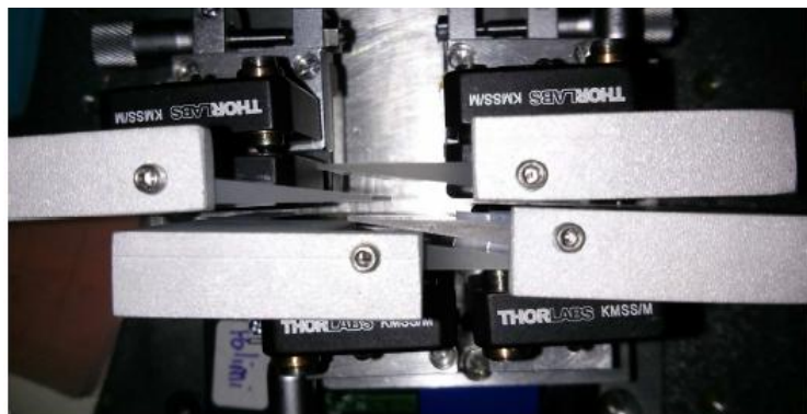
FIGURA 4.2.4. Vista dall'alto delle wedges.
