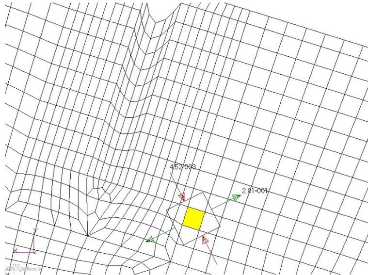
Figura 95: Tensore delle deformazioni piano dell'elemento con il massimo FI
