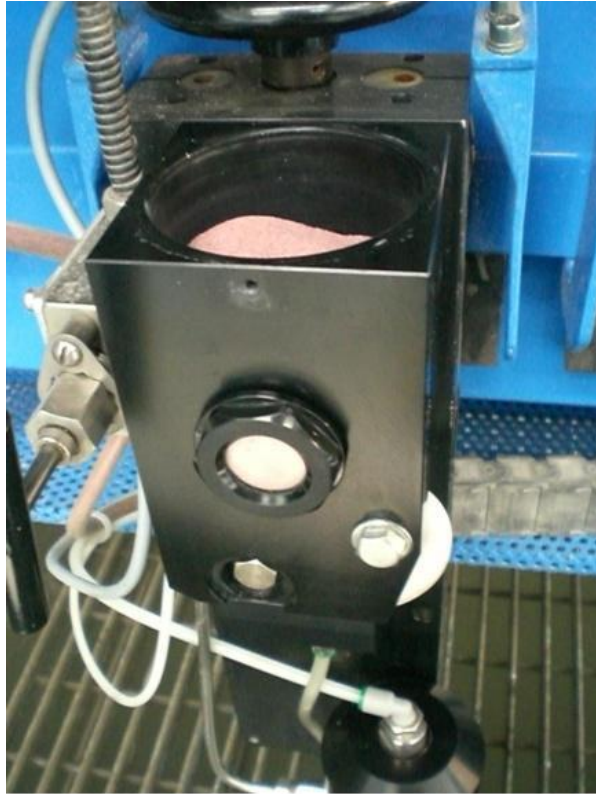
Figura 2.9 Tramoggia a monte della testa di taglio [1]
