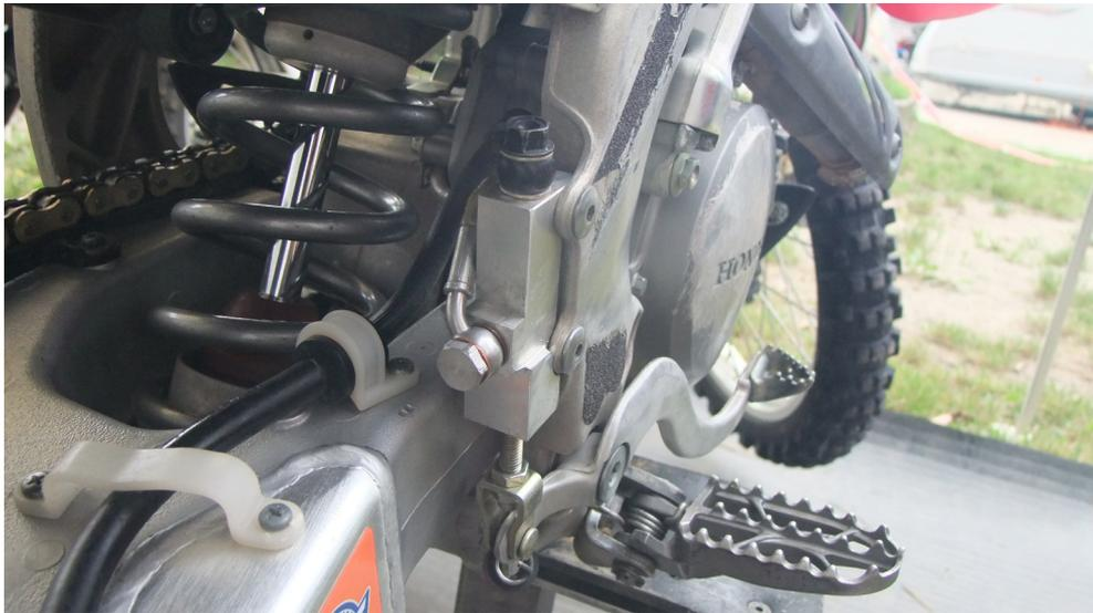
*Foto 11: Prototipo pompa a pedale montato sul veicolo*
