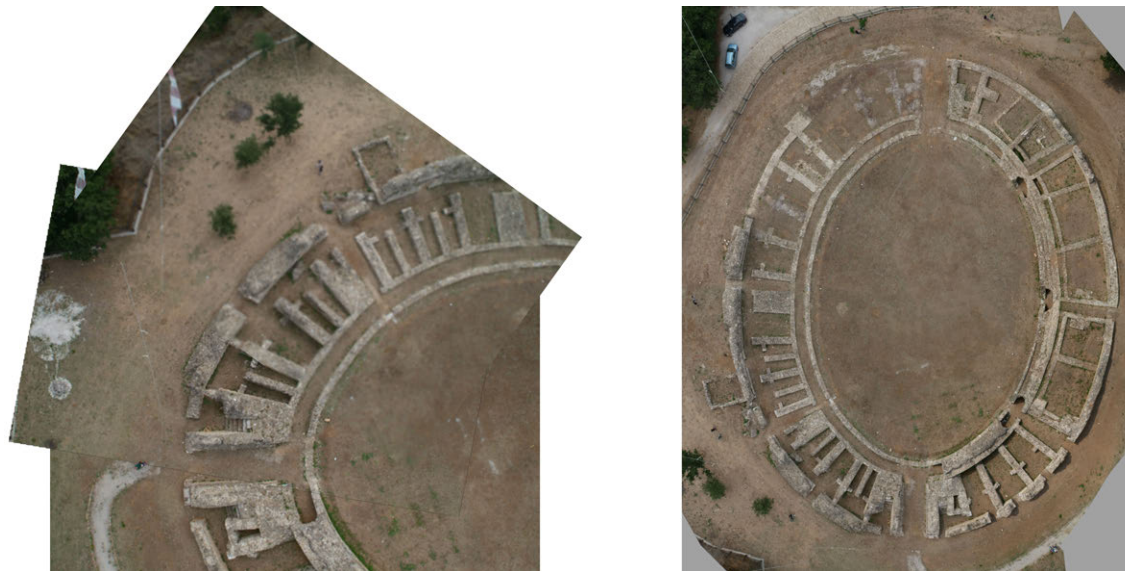
Figura 3: Alcuni fotogrammi, parte di una strisciata, acquisiti sull'anfiteatro. A destra: il risultato finale.
