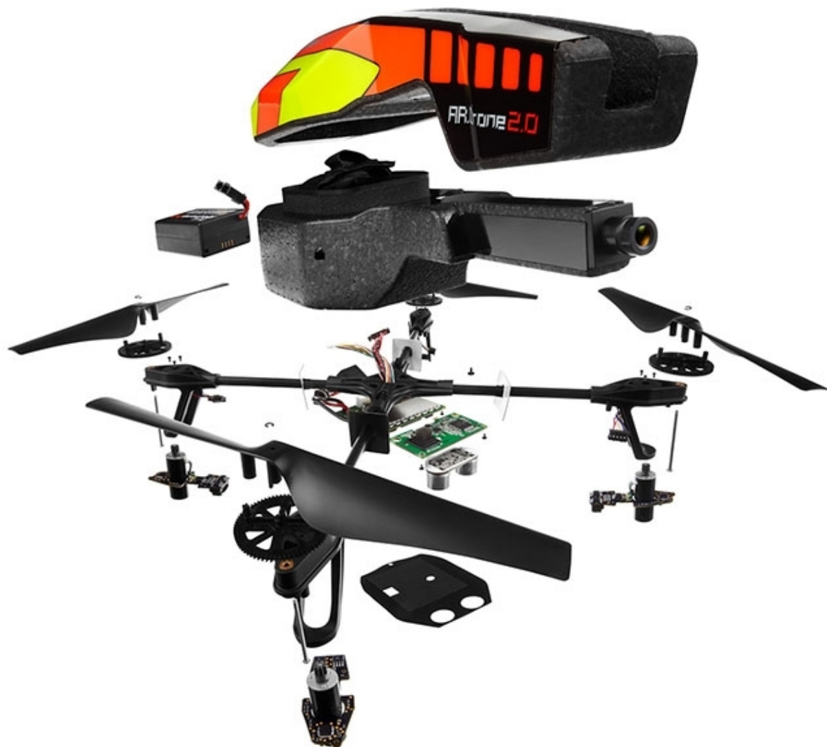
Figura 48: Le componenti del Parrot Ar.Drone 2.0.
