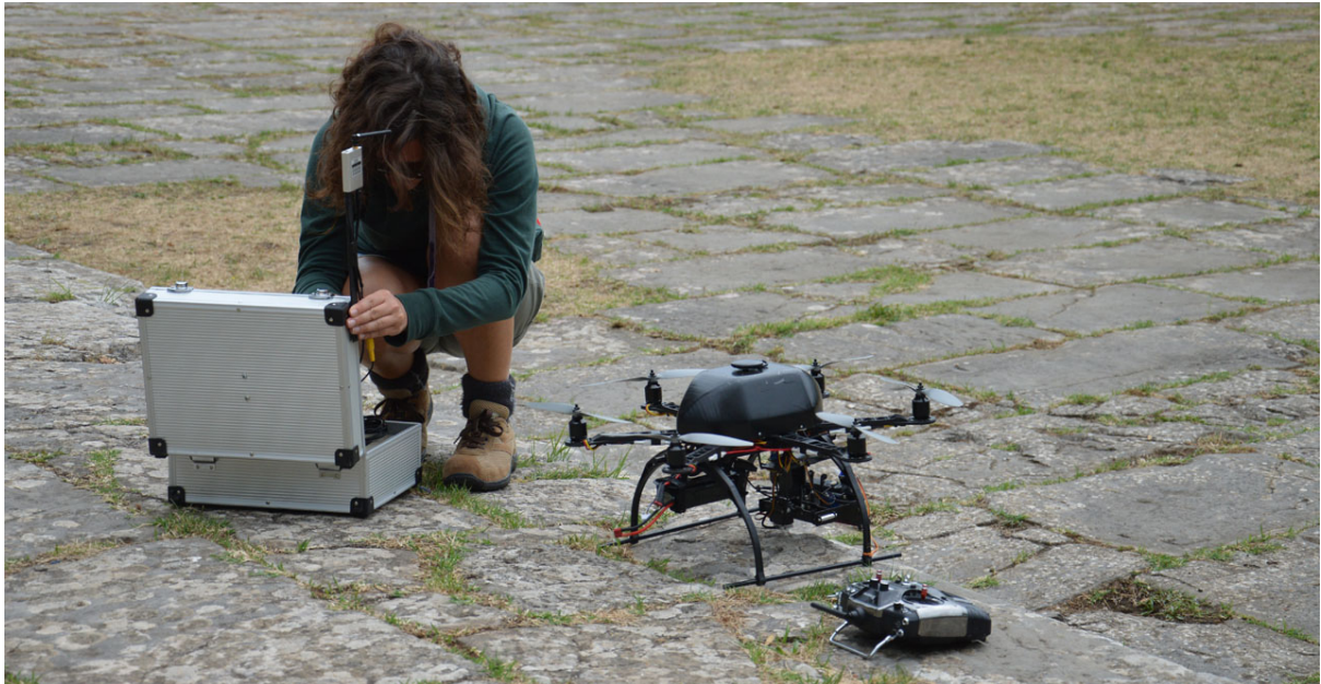
Figura 58: L'elicottero con la stazione a terra e il radiocomando.
