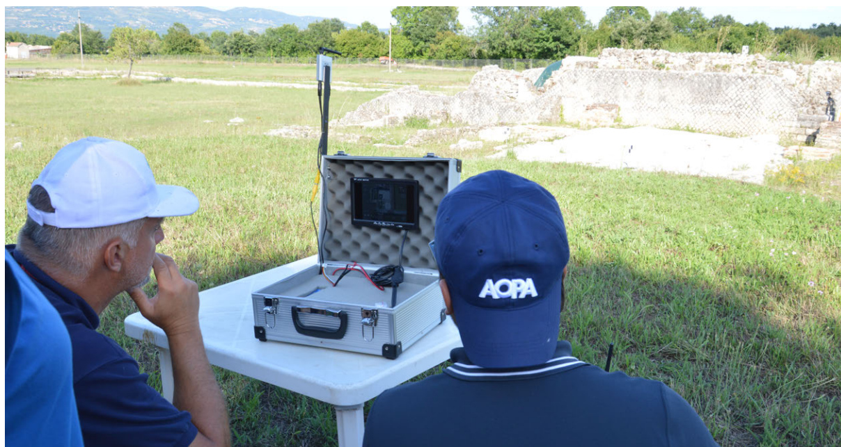
Figura 5: La stazione a terra del sistema micro UAV utilizzato sul sito.
