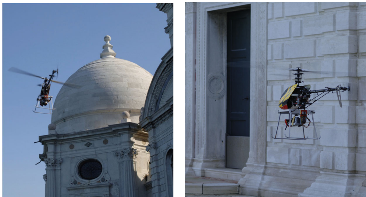
Figura 9: Il vettore aereo utilizzato per il rilievo della facciata di San Michele.
