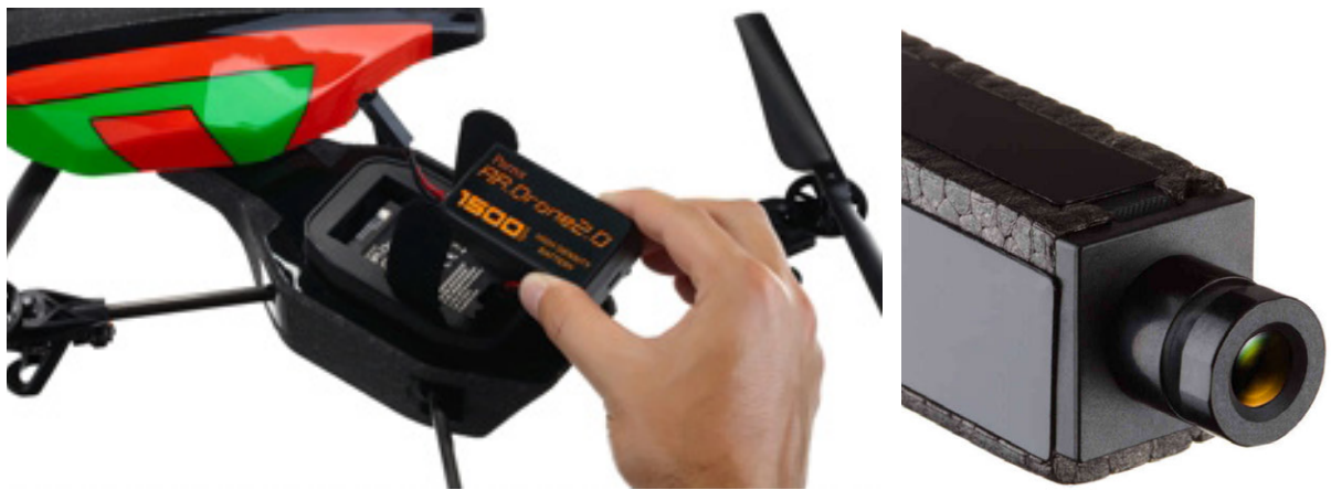
Figura 50: a) A sinistra: la batteria e il suo alloggiamento; b) A destra: la telecamera frontale.
