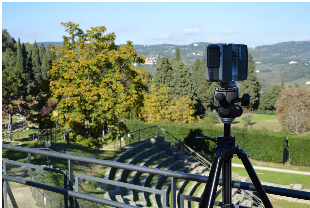
Figura 19: Rilievo laser scanning con Faro Focus 3D.
