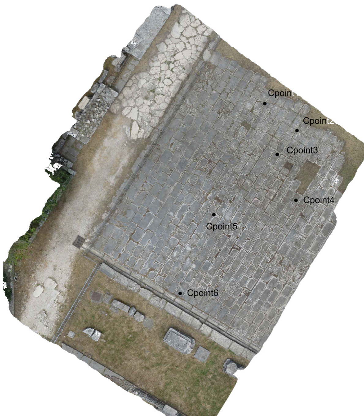
Figura 135: L'ortofoto S100 esportata con pixel di 5 mm con la posizione dei checkpoints analizzati.
