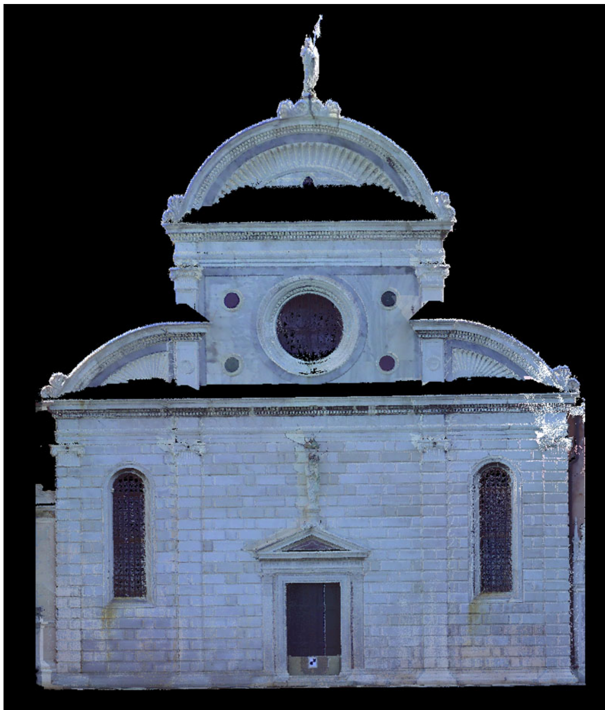
Figura 11: Proiezione ortogonale della nuvola di punti della facciata acquisita tramite laser scanner.
