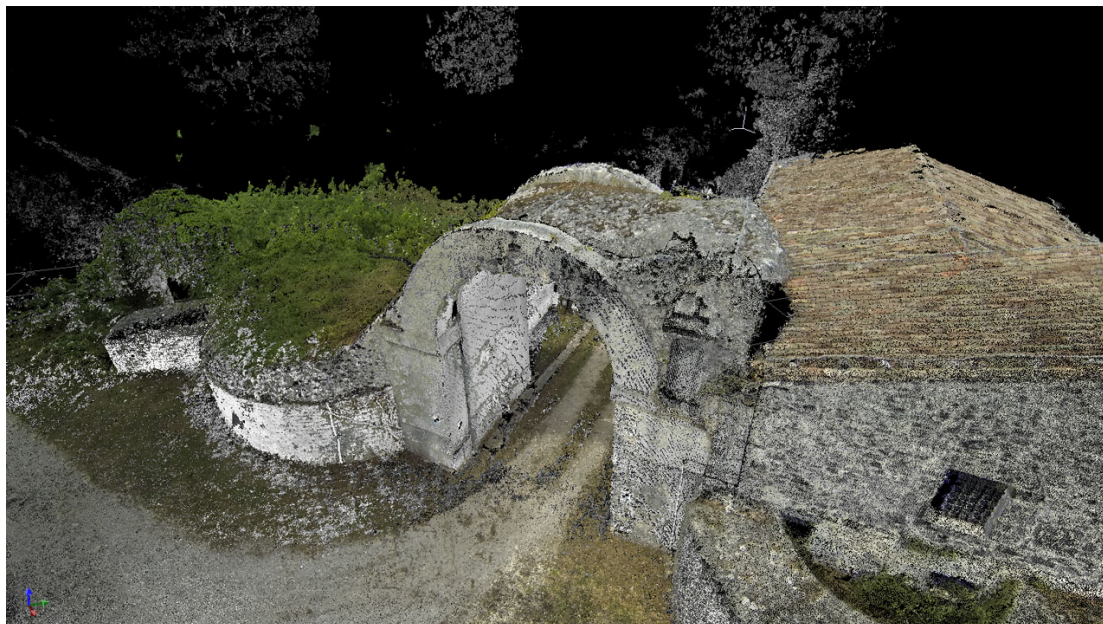
Figura 149: Le due nuvole di punti (Faro e GoPro) nello stesso sistema di riferimento.
