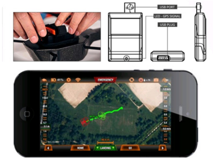
Figura 52: Il modulo GPS e l'interfaccia su tablet o smartphone.
