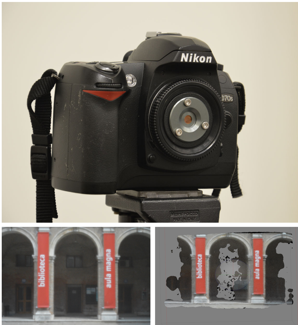
Figura 64: Sopra: Nikon D70 con foro stenopeico; A sinistra: un'immagine acquisita con foro stenopeico; a destra: un modello costruito a partire da un set di immagini acquisite da questa fotocamera. La qualità dell'immagine, come si vede, non è sufficiente per ottenere un modello fotogrammetrico utilizzabile.
