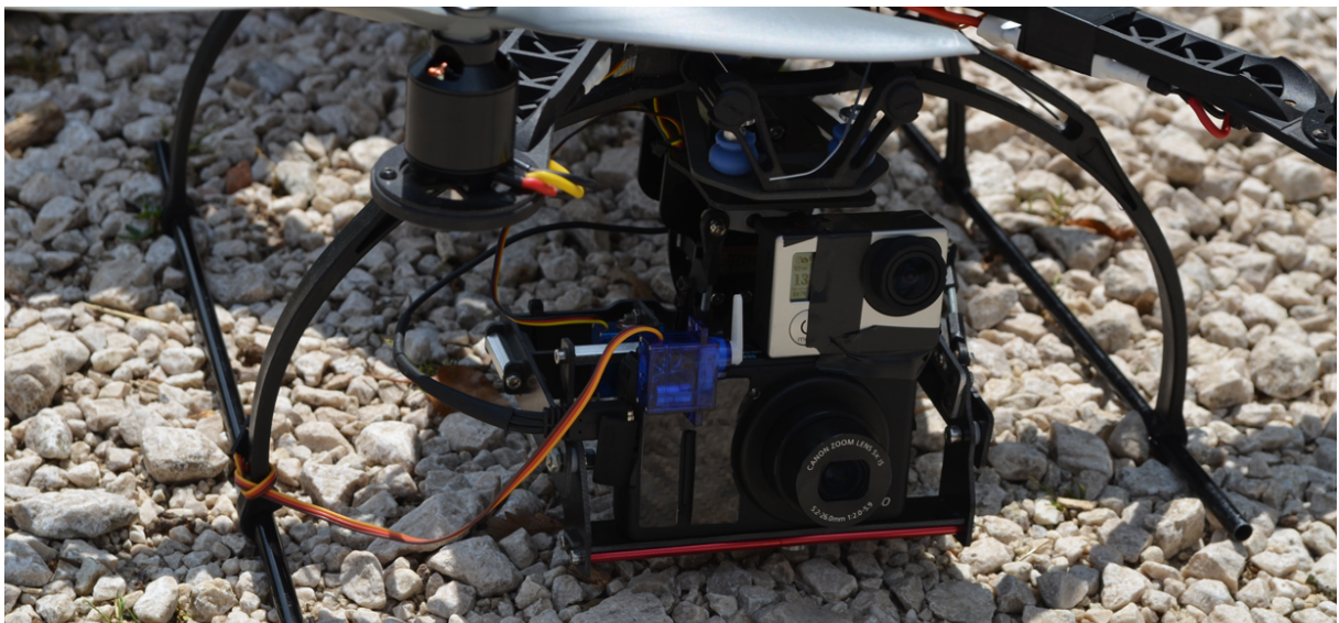
Figura 139: Entrambe le fotocamere sono state montate sull'esacottero.
