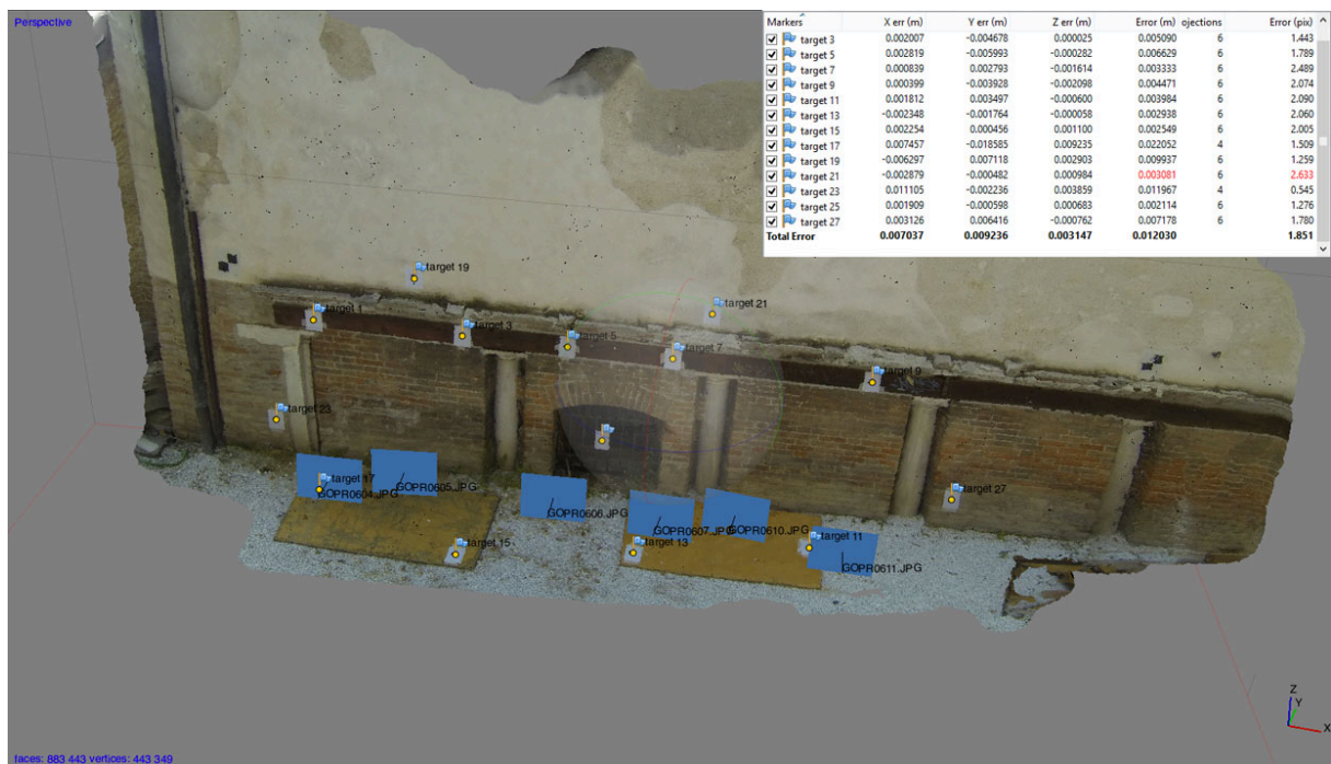
Figura 104: Il modello costruito a partire dalle foto originali GoPro, con i relativi residui sui GCPs.
