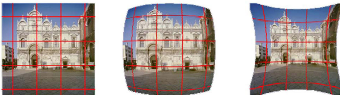
Figura 68: A sinistra: immagine corretta; al centro: distorsione a barilotto; a destra: distorsione a cuscinetto.
