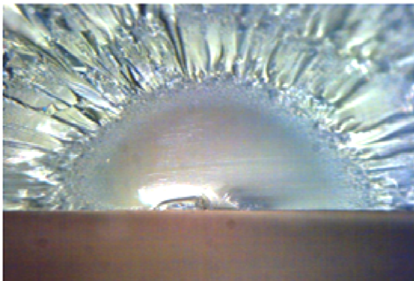
Figura 41: Esempio di cricca in stato avanzato di propagazione.
