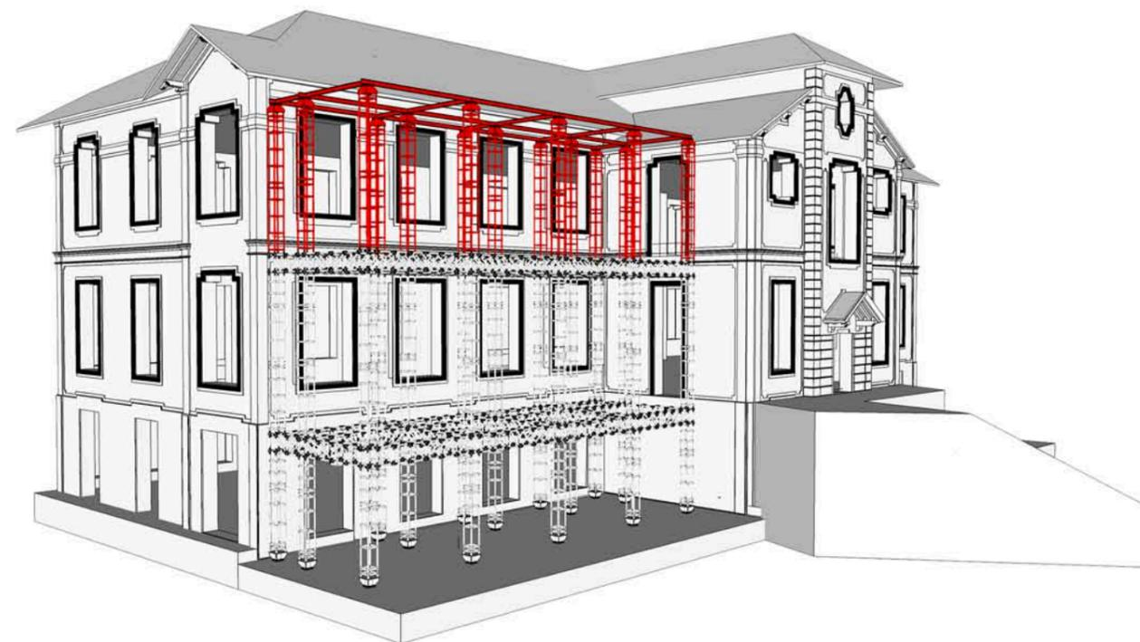
*FASE 5: Realizzazione degli orizzontamenti dei piani terra e primo; contemporanea posa dell'isolamento controterra e successivo getto del massetto impiantistico.*
