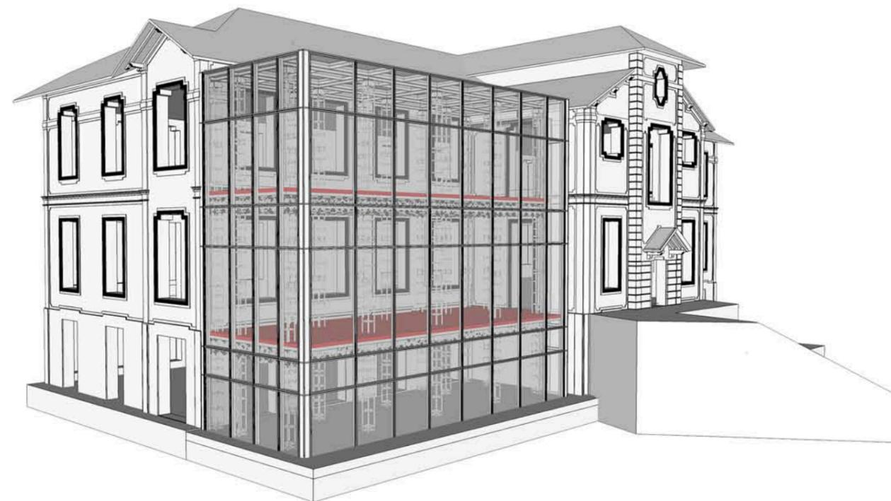
*FASE 9: Realizzazione della sottostruttura del sistema di oscuramento della facciata e contemporaneo posizionamento degli oscuramenti interni della copertura.*
