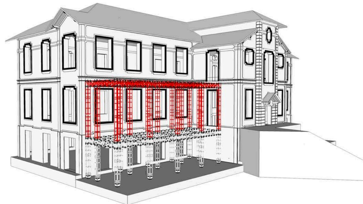
*FASE 4:* Realizzazione della struttura del piano primo: incastro dei ritti a quelli del piano inferiore, assemblaggio dell'elemento di regolazione superiore, finale posizionamento ed ancoraggio delle travi IPE 100 della copertura.
