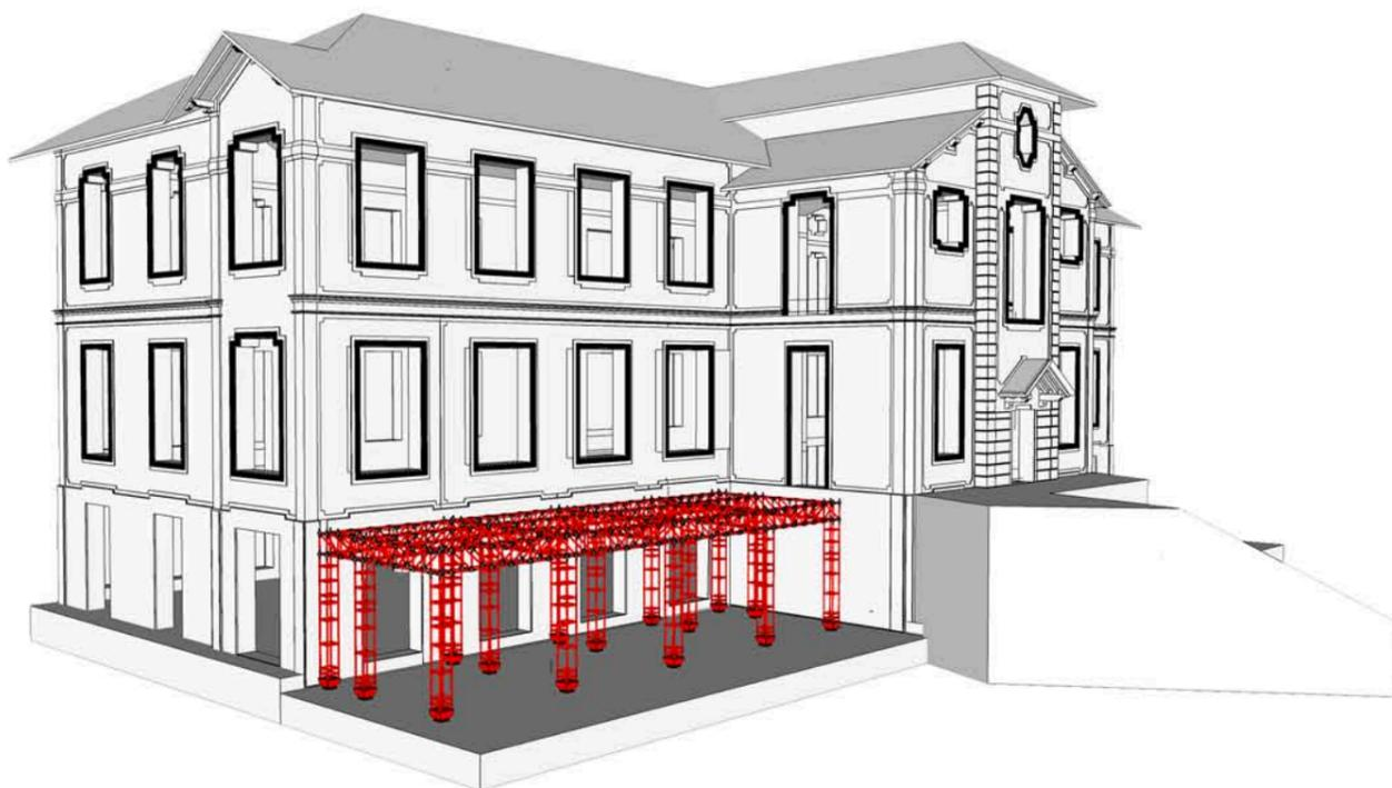
*FASE 3:* Realizzazione della struttura del piano terra: incastro dei ritti a quelli del piano inferiore, assemblaggio a piè d'opera dei tratti del graticcio reticolare a doppia orditura, finale posizionamento ed ancoraggio del graticcio ai ritti.
