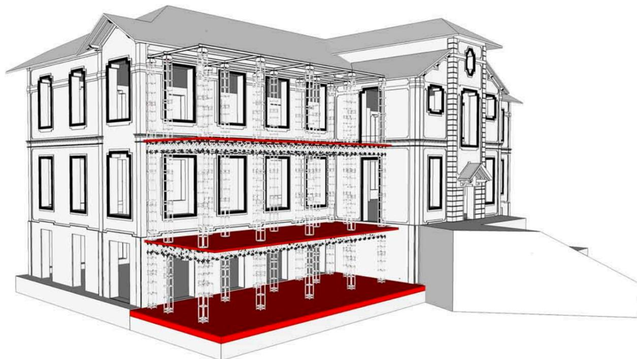
*FASE 6: Assemblaggio della struttura a montanti e traversi della facciata continua autoportante.*
