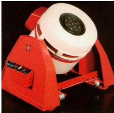
Figura 1.7: esempio di vibrodina elettrodinamica.
