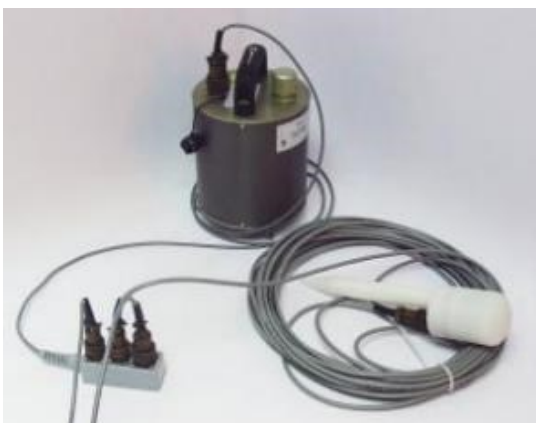
Figura 1.15: a) accelerometro per applicazioni civili; b) velocimetro per applicazioni civili; c) sismometro; d) trasduttore di spostamento di tipo LVDT.
