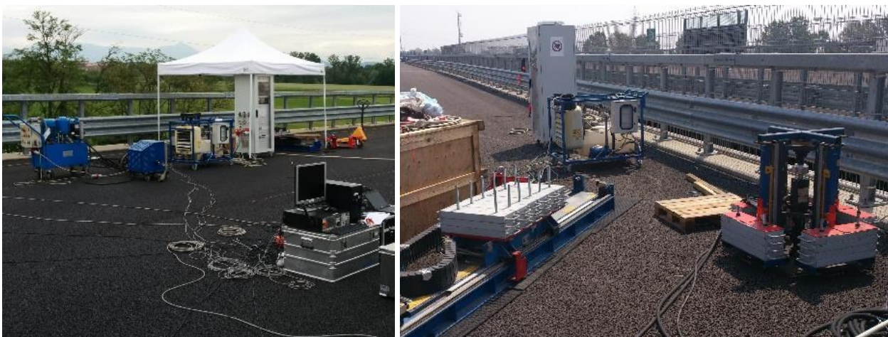
Figura 1.20: strumenti impiegati nelle prove con forzamento sui viadotto Oglio e Muzza. I sistemi di eccitazione in ambito civile sono ingombranti (pesi di 500-700 Kg) e complessi (richiedono pompe per il controllo e generatori che alimentino le pompe). Il set-up di prova comprende in ogni caso tutta la strumentazione messa in opera per la prove con eccitazione ambientale.
