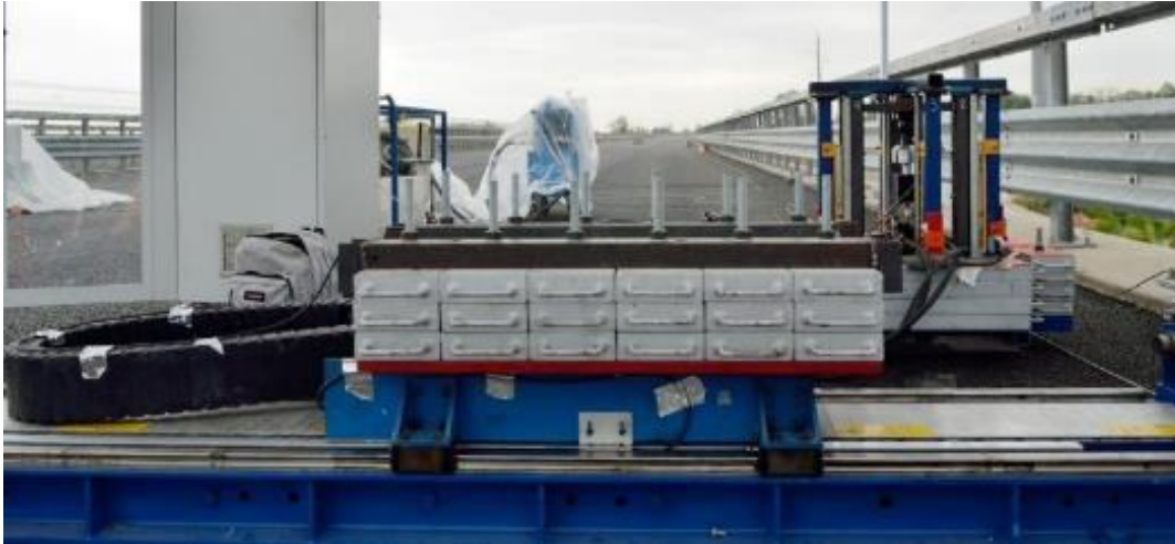
Figura 4.10: motore elettromagnetico lineare (in primo piano) e pistone oleodinamico (dietro a destra) posizionati sul viadotto Oglio.
