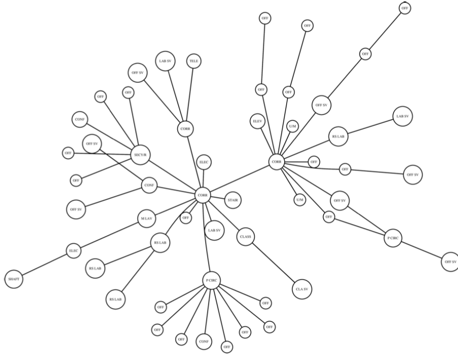
Figura 2.8: Esempio di grafo di un edificio, tratto da [4]. I nodi nel grafo possiedono label che indicano la categoria di quella stanza come cucina ufficio, corridoio.
