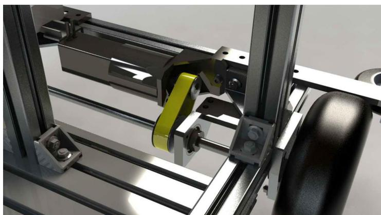
**Figura 5.13:** Il motore vincolato al telaio.
