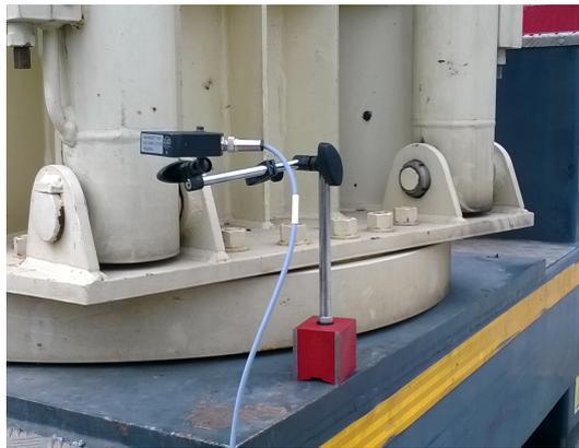
Figura 5.6: Distanziometro alla base del montante.
