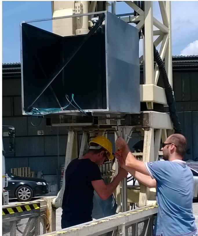
**Figura 5.15:** Regolazione del piano degli spot; si possono notare i pannelli neri utilizzati per proteggere dalla luce del sole.
