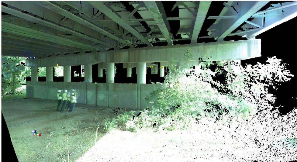
**Figura 1.7:** Modello 3D di un impalcato, ottenuto tramite acquisizione statica terrestre [16].
