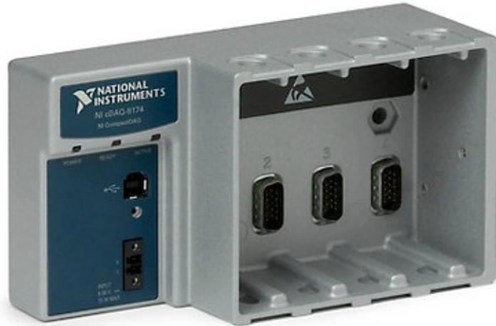
**Figura 5.20:** Compact DAQ della National Instruments
