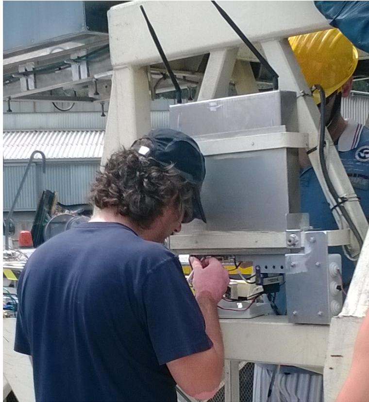
**Figura 5.23:** Fissaggio del PC sul by-bridge (nella scatola metallica); si possono notare sopra il PC le antenne per la rete Wireless, e sotto il Compact DAQ.
