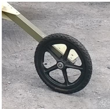
**Figura 5.1:** L'odometro utilizzato nelle prove sperimentali.
