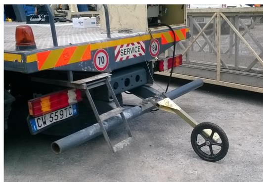
**Figura 5.5:** Ancoraggio dell'odometro al camion.
