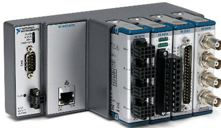
**Figura 5.18:** Compact RIO della National Instruments, con installati alcuni moduli
