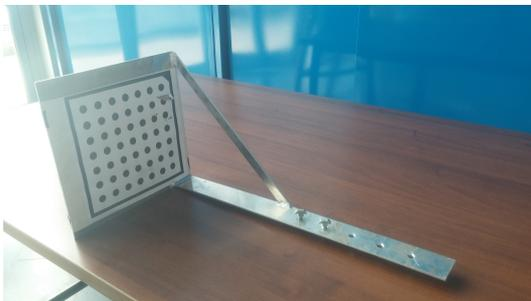
(a) Pattern di calibrazione per la telecamera laterale
