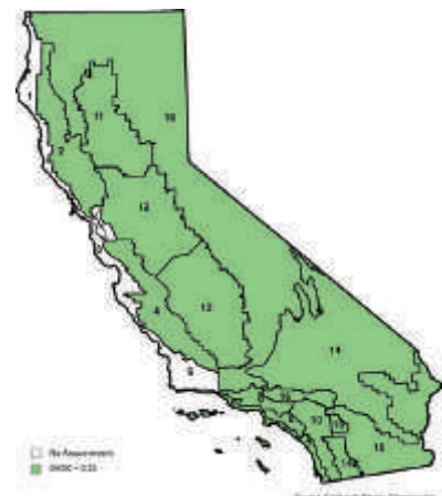
Fig.11.1.19- Zone climatiche in cui sono previste limitazioni per le performance dei serramenti ( tutte appartate la zona 1-3-5). Rientrano in prescrizione le zone 8 (Irvine, luogo esposizione ) e 12 ( Sacramento, luogo di costruzione definitiva del padiglione )
