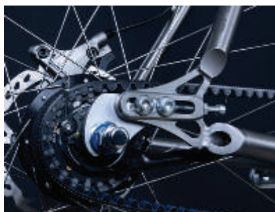
Fig.10.4.6-cyclette elettrica, componente cinghia di trasmissione.
