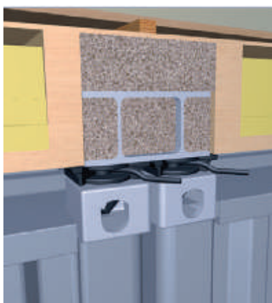
Fig.11.1.14 Particolare in sezione e modellazione 3d del sistema di copertura
