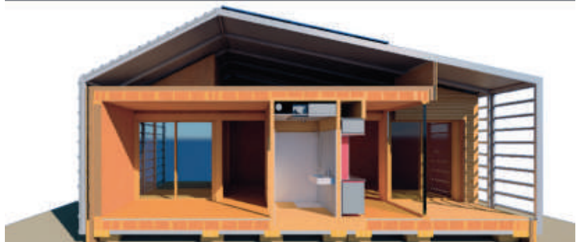
Fig.9.4.3 -RhOME for denCity, spaccato stratigrafico dell'unità abitativa
