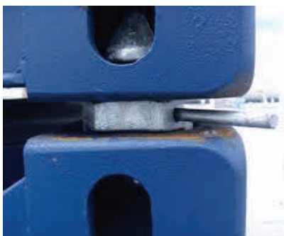
Fig.5.1.10 - Immagini del fissaggio dei due containers mediante sistema a double twist lock
