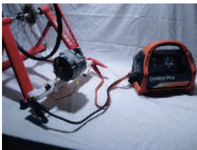
Fig.10.4.5-cyclette elettrica, schema circuito di produzione energia.
