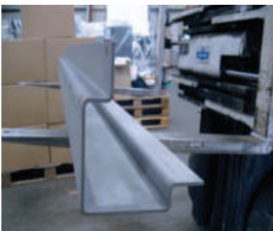
Fig.5.4.8 Foto pilastro angolare del container
