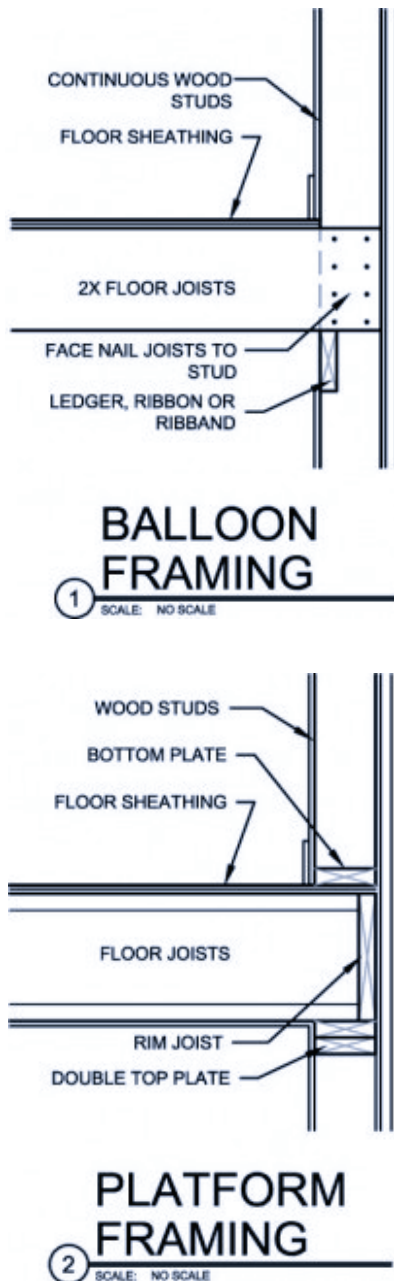
Fig.3.1.68 - Confronto dell’evoluzione del sistema da Balloon a Platform Frame. Immagine del nodo di unione di un piano
