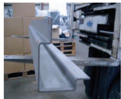
Fig.11.1.12 Foto pilastro angolare del container
