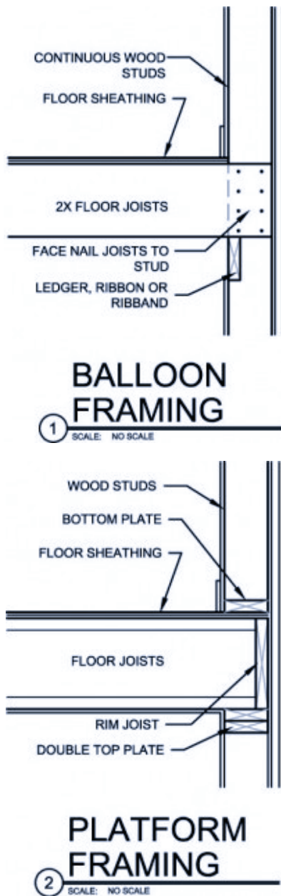
Fig.3.2.2 - Nodo costruttivo di unione del solaio di interpiano della versione a Balloon Frame e nell'evoluzione del Platform Frame
