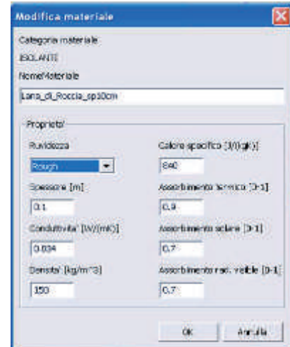
Fig.11.3.3 -Inserimento dei dati termo-fisici delle singole componenti del pacchetto tecnologico
