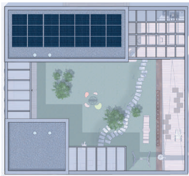
Fig.11.3.17 -Copertura del padiglione con impianto fotovoltaico concentrato sul corpo principale del padiglione.
