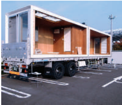
Fig.4.3.10 - Foto del trasporto su gomma dei moduli abitativi Ex-container project, Japan, Yasutaka Yoshimura Architects,
