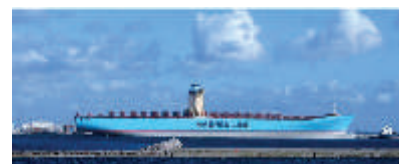
Fig.5.2.13 MAERSK E-CLASS Nave porta-container Stazza lorda 170974t - Lunghezza 397m (1302 ft) - Larghezza 56m (184 ft) - Capacità di carico 11. 000 – 14. 770 TEU
