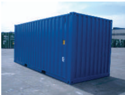
Fig.5.3.1 Container serie 20' o 40' versione normale o high cube secondo standard iso
