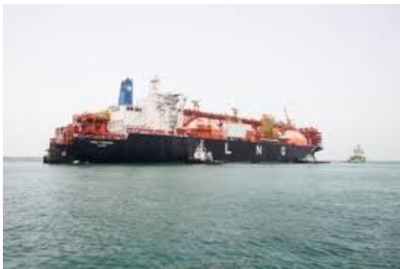
Immagine 2.23: Rigassificatore Offshore FSRU; fonte www.greenreport.it
