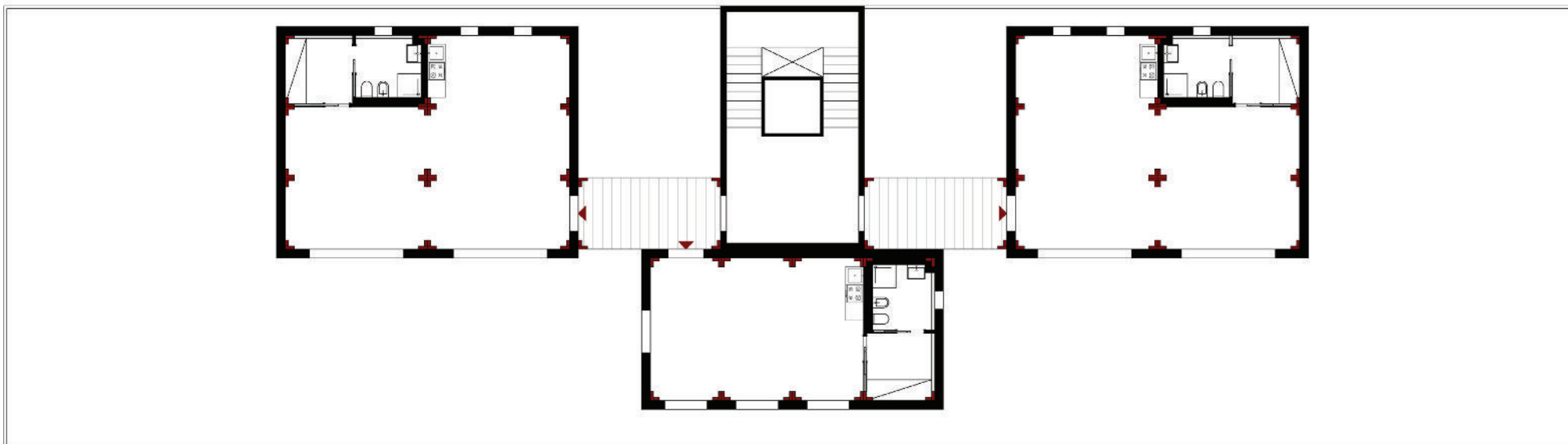
Fig. 1.2.3 _ Ipotesi di aggiunte in copertura su un edificio a stecca _ Planimetria _ Scala 1:200
