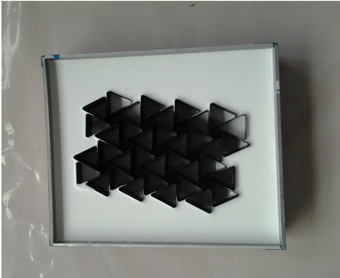
Figura 35: Colata di gomma per produrre la cornice esterna
