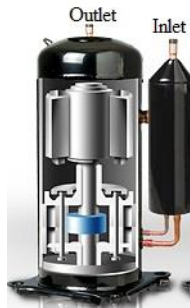
Figura 3.6: sezione del compressore di tipo rotary.
