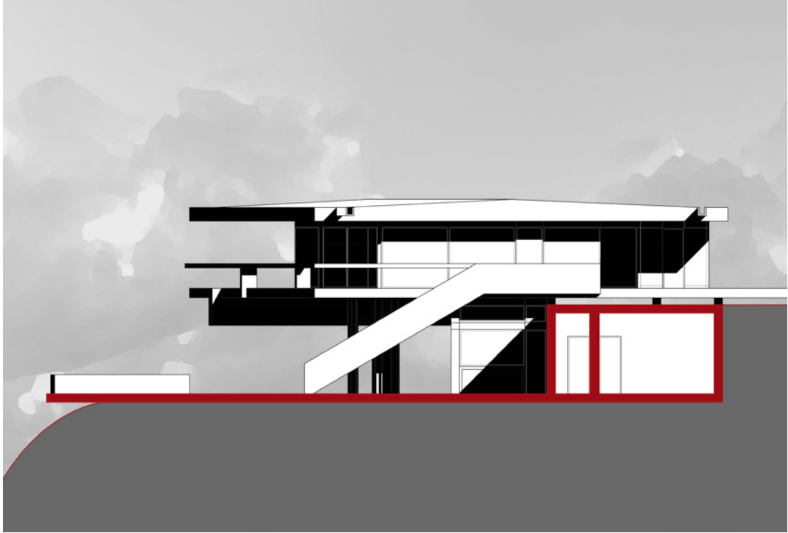
Ridisegno del Prospetto Nord, Progetto Definitivo, scala 1:200
