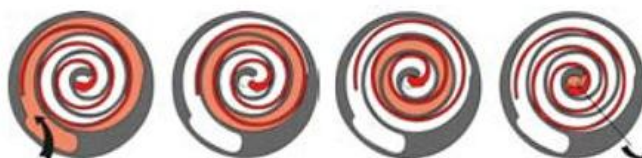
Figura 1.9 Schema funzionamento compressore scroll
