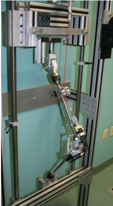
Figura 3.2: Rappresentazione di Oxford Rig . Il femore e la tibia sono rappresentate da barre di acciaio, il muscolo quadricipite è un cavo d'acciaio, la rotula ed il tendine sono costituite da un cinturino in nylon. Sono stati utilizzati un giunto universale a livello dell'anca ed un giunto sferico per l'articolazione della caviglia. La traslazione verticale del bacino crea la flessione del ginocchio.
