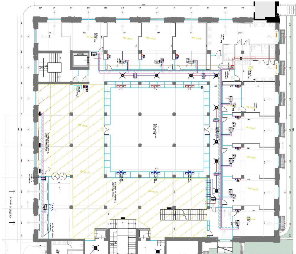
Figura 4.27 - Piano terra: impianti aeraulici ed idronici
