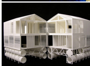
Fig. 17 Principio di galleggiamento E - Maison Flottante (Canada) - MOS Arch.
