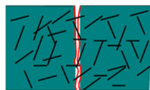
Fratture di entità omogenea con STRUX 90/40
