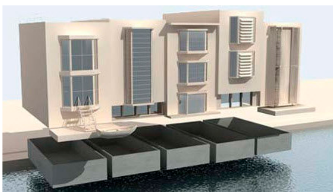
Fig. 15 Principio di galleggiamento B - Canal-Houses (Amsterdam), Waterstudio
