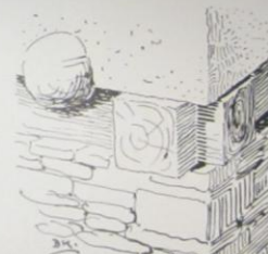
Abb. 349. Ecklösung zweier sich treffenden Mauerthwellen.
