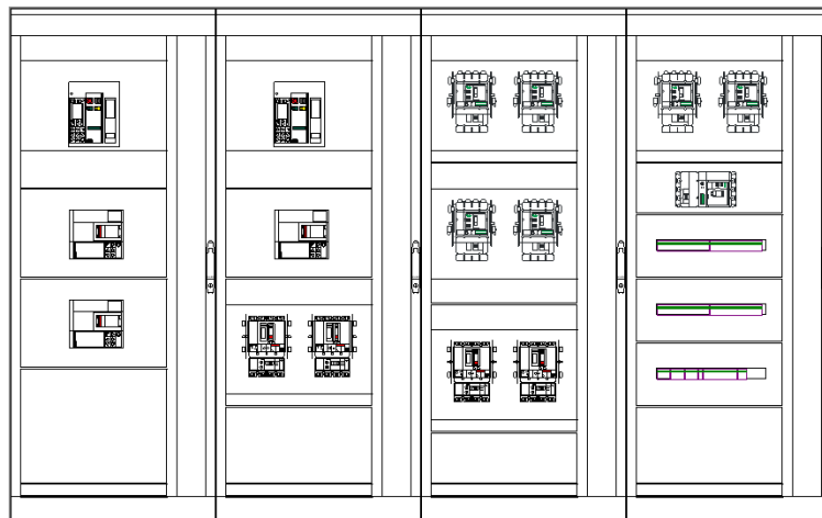
Fig. 3. 4: Fronte quadro Power Center
