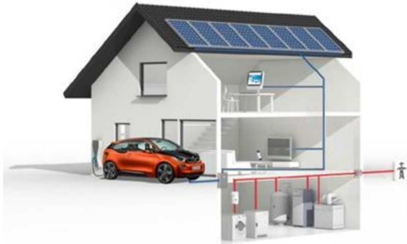
Fig.4.2: Generazione mediante fotovoltaico e allaccio diretto dei carichi alimentati in corrente continua. Si può prevedere la presenza di convertitori DC/DC per i carichi che necessitano tensioni differenti da quella di produzione (es. Ricarica auto) e l'allaccio alla rete per i carichi funzionanti in alternata.
