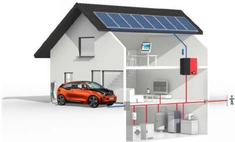
Fig.4.1: Generazione di energia mediante impianto fotovoltaico. La corrente continua prodotta dall'impianto fotovoltaico è convertita in alternata attraverso l'inverter e distribuita ai carichi.
