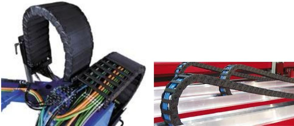
Figura 2.3 Catene portacavi per il collegamento di organi in movimento
