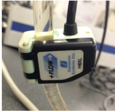
Figura 3.35 – Sonda del flussimetro montata correttamente sul tubo.
