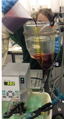
Figura 3.58 – Riempimento del circuito con sangue bovino.
