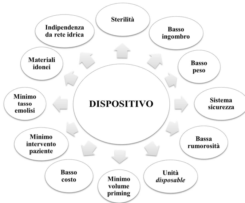
Figura 3.1 – Schema riassuntivo delle specifiche di progetto del dispositivo portatile per emodialisi.
