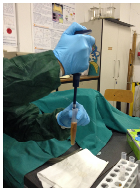
Figura 3.63 – Prelievo del plasma tramite spipettatore.
