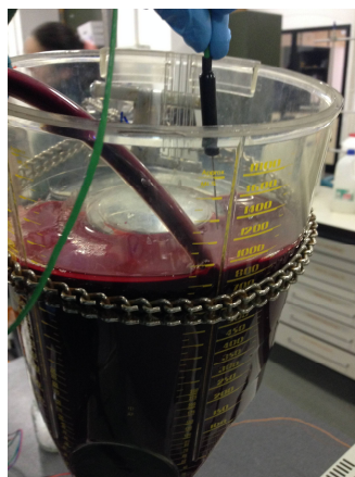
Figura 3.60 – Inserimento della sonda per l'acquisizione della temperatura del sangue.
