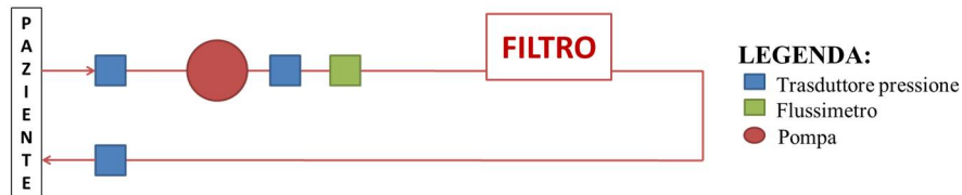
Figura 3.64 – Schema del circuito di prova.
