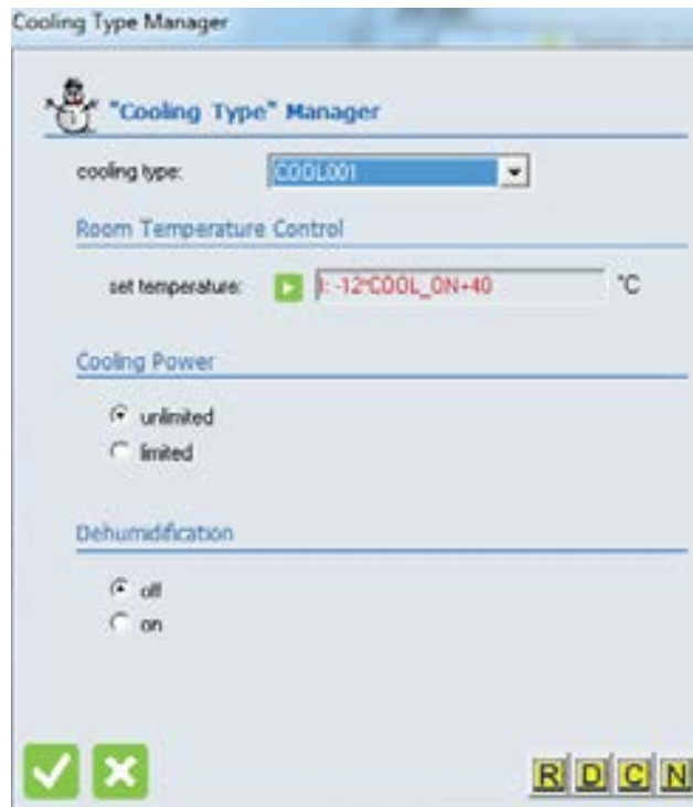
Fig.027 Finestra di impostazione del raffrescamento in TrnBuild
