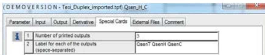
Fig.033 Finestra di impostazione del componente Type 28b, scheda Special Cards
