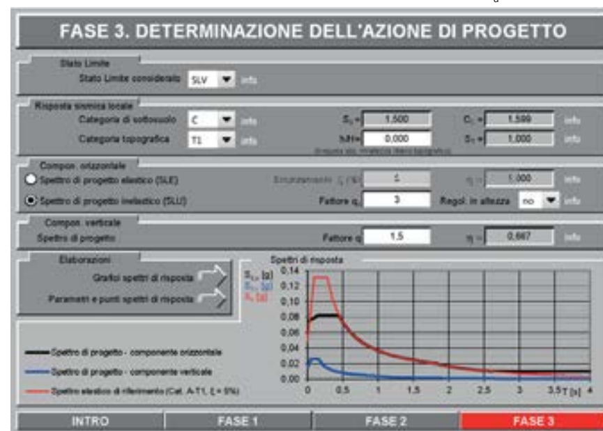
Fig.013 Spettro di risposta elastico di progetto, software Spettri di risposta
