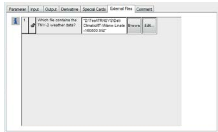
Fig.010 Finestra variabili del Type 15-2, scheda External Files
