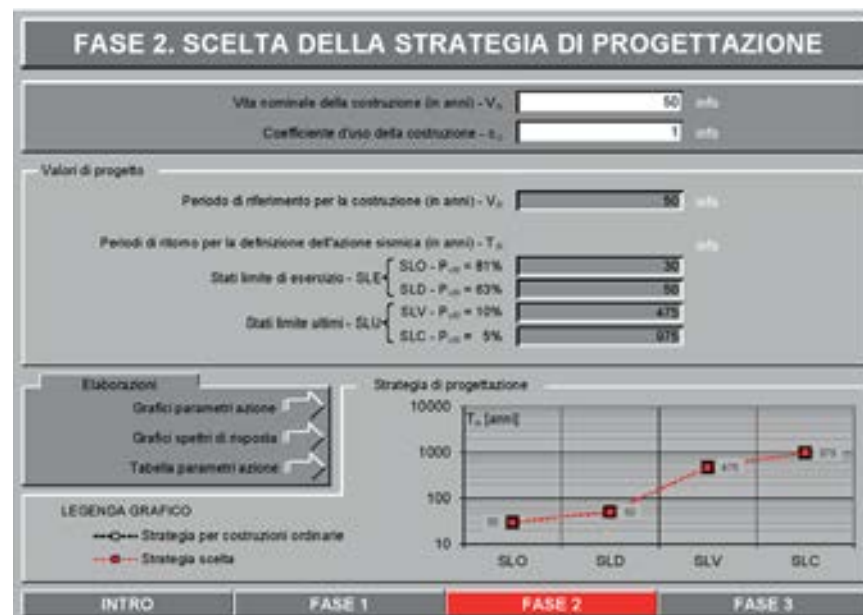
Fig.007 Tempo di ritorno di progetto, software Spettri di risposta
