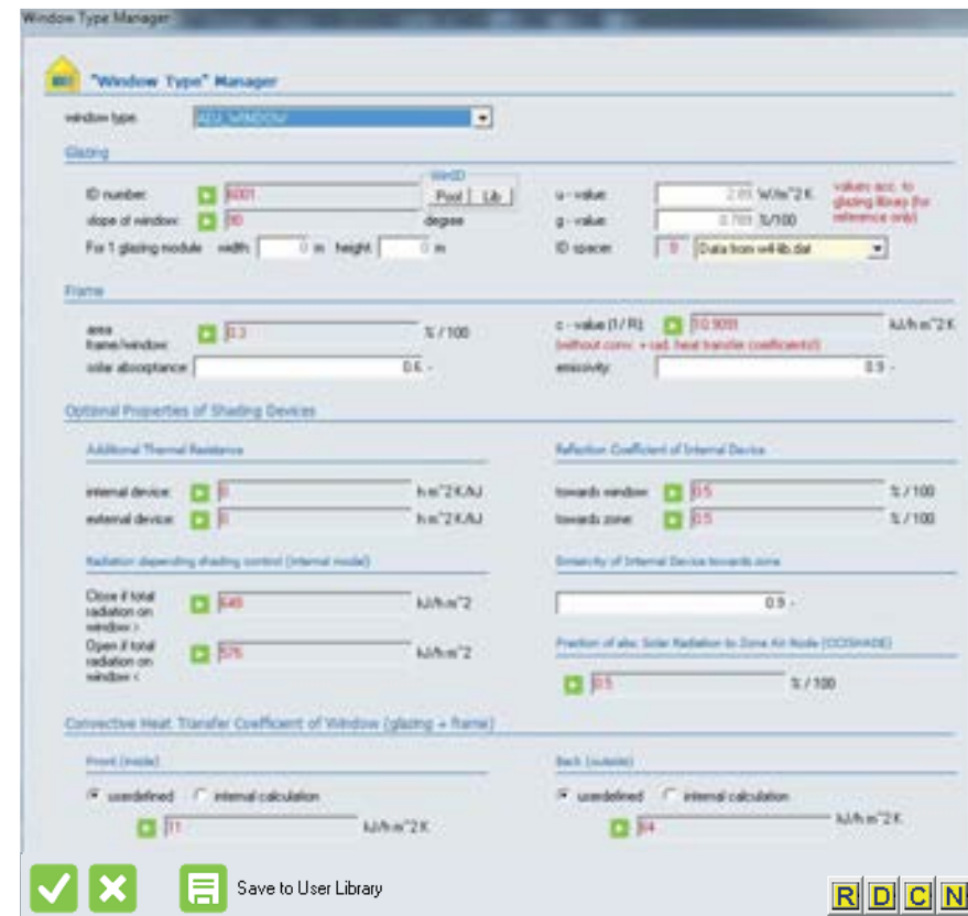
Fig.022 Finestra di impostazione degli infissi in TrnBuild
