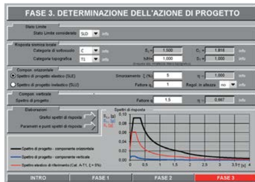
Fig.010 Spettro di risposta elastico di progetto, software Spettri di risposta
