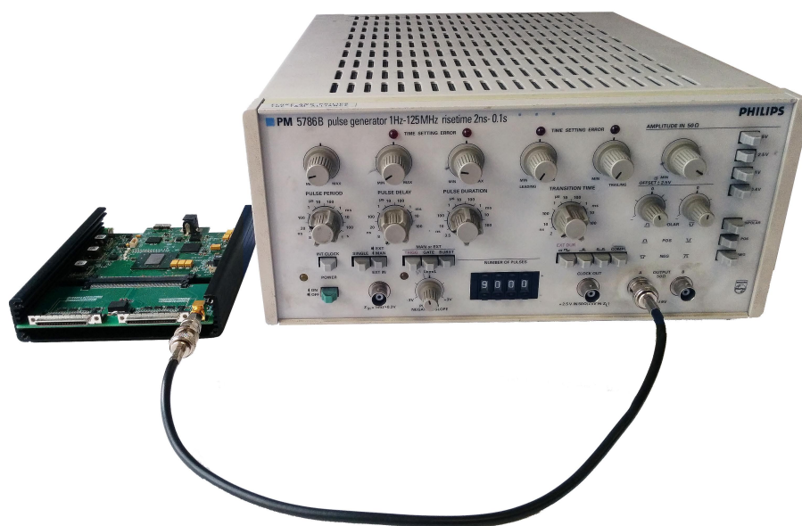
Figura 4.5: Figura che mostra il setup utilizzato per l'esperimento. Un generatore di impulsi collegato alla scheda.
