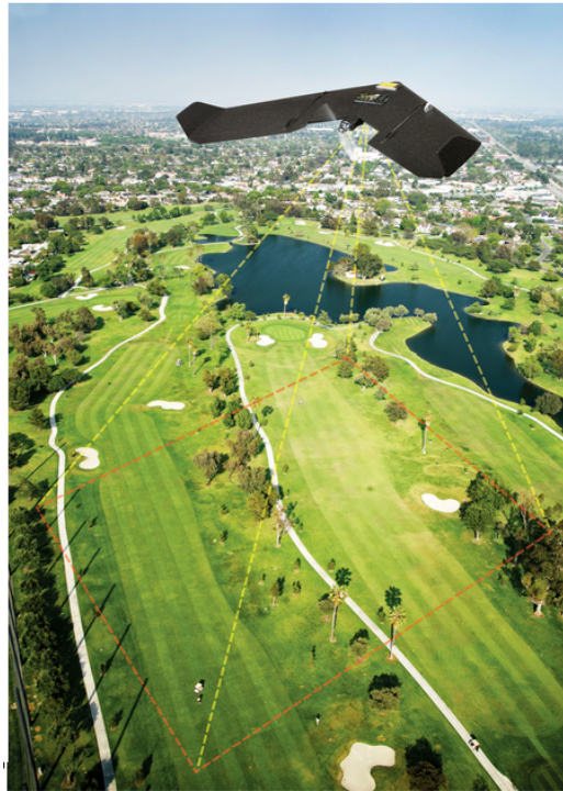
Figura 1.2: Un aeromobile a pilotaggio remoto durante una missione di acquisizione immagini
