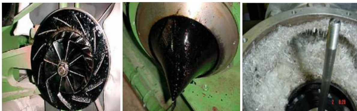
Figura 46 - Depositi per condensazione di tar e naftalene a seguito dell'uso di syngas da legno (131) .
