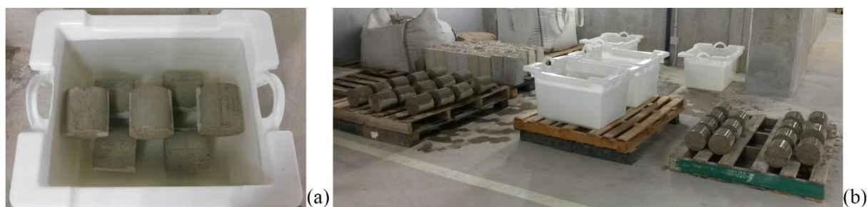
Figura 3-23: Cicli bagnato/asciutto: immersione in acqua dei campioni (a), esposizione all'aria di laboratorio (b).
