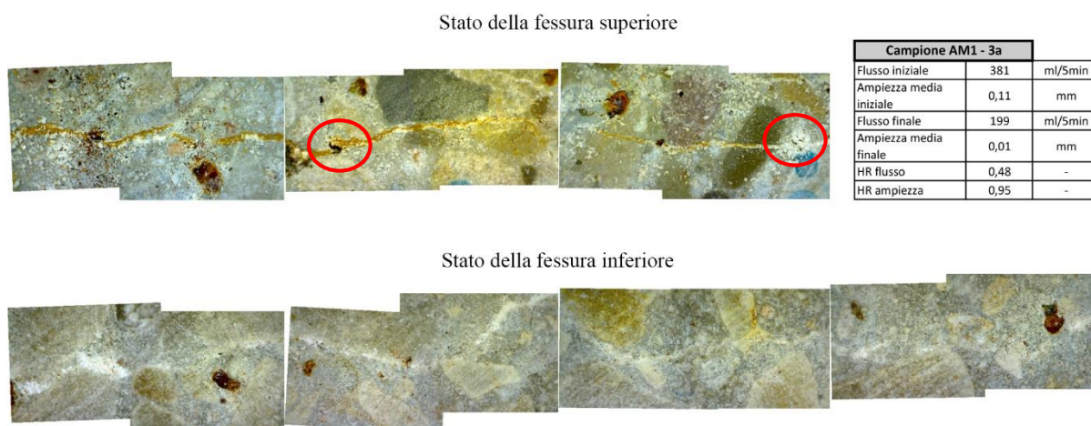
Figura 4-33: Stato della fessura superiore e inferiore dopo il periodo di cura. Campione in esame 3a dell'impasto di controllo AM1 e con rapporto a/c di 0,45. In allegato una tabella con i rispettivi valori iniziali e finali.
