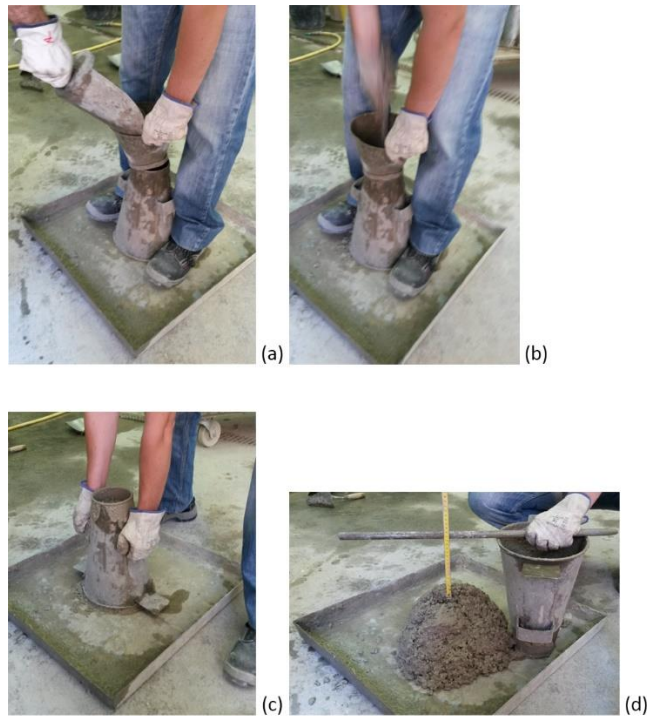
Figura A-1: Prova di abbassamento al cono: inserimento del conglomerato nello stampo (a), costipazione del calcestruzzo mediante la barra di acciaio (b), sollevamento del cono in un tempo compreso tra 5 s e 10 s (c), misurazione della distanza tra il punto più alto del calcestruzzo e la barra (d).
