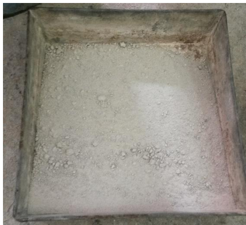
Figura 3-7: Aspetto dell'additivo cristallino al momento della fabbricazione del calcestruzzo.
