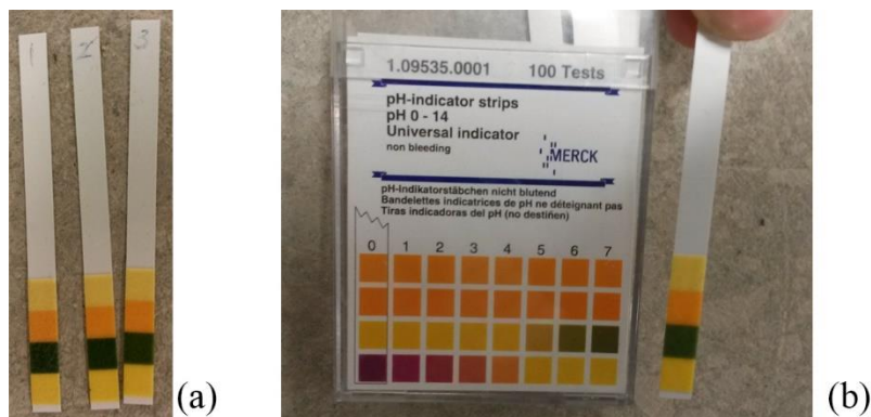
Figura 3-21: Cartine indicatrici di pH utilizzate (a), riscontro del colore ottenuto con quello di riferimento (b).
