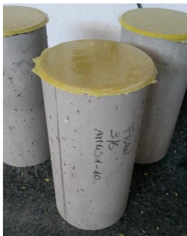
Figura A-4: Cappatura della superficie superiore del campione utilizzando una miscela di zolfo.
