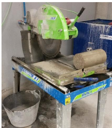
Figura 3-15. Sega circolare per calcestruzzi utilizzata per asportare le facce esterne dei campioni e, successivamente, dividerli a metà.
