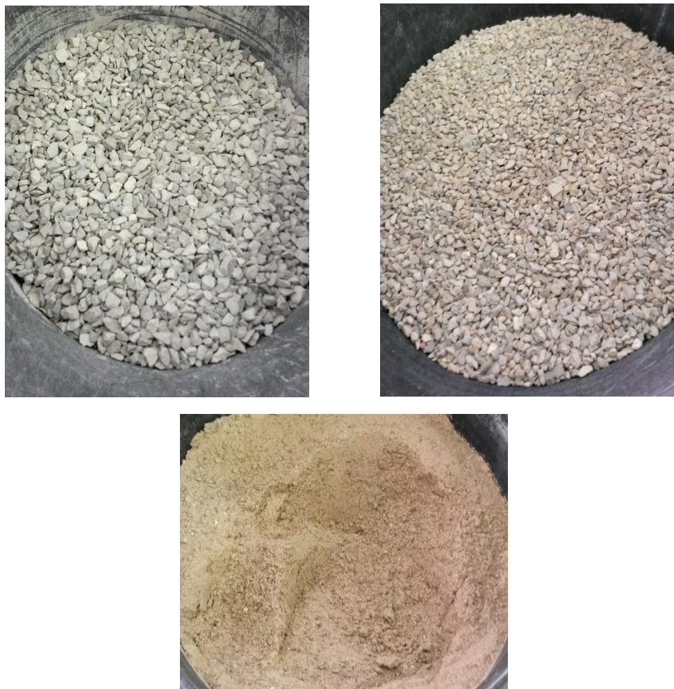
Figura 3-4: Foto dell'aspetto del pietrisco 7/12 (in alto a sinistra), 4/7 (in alto a destra) e della sabbia (in basso).
