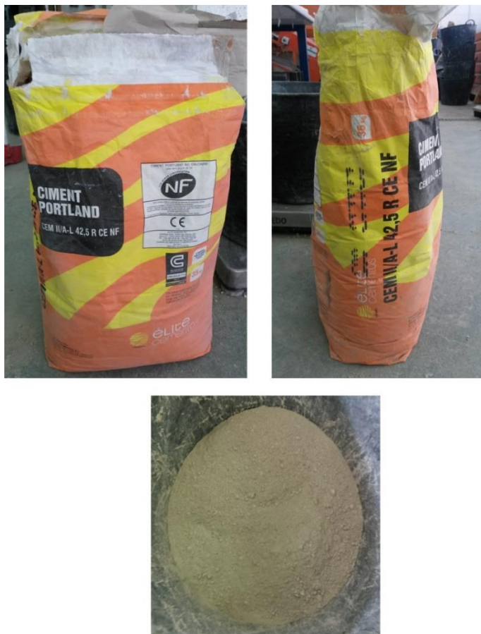
Figura 3-3: Cemento CEM II/A-L 42,5 R. La confezione (in alto), aspetto del materiale (in basso).
