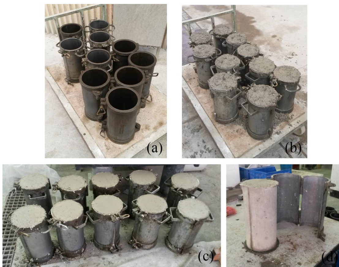
Figura 3-14: Preparazione delle forme inumidendone le superfici con disarmante (a), calcestruzzo compattato (b), lisciatura delle superfici e riposo dei campioni per 24 ore (c), disarmo dei campioni e sistemazione in camera umida (d).
