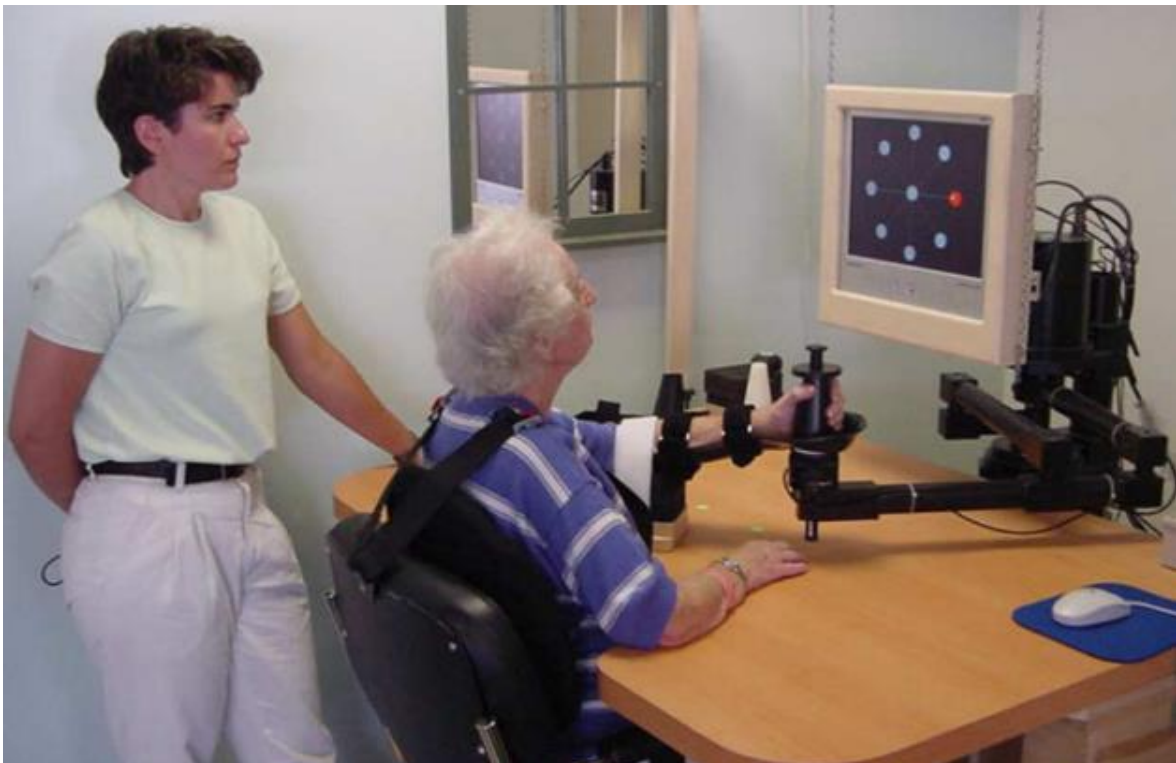
Figura 11 Sistema MIT MANUS (Volpe et al. 2007)
