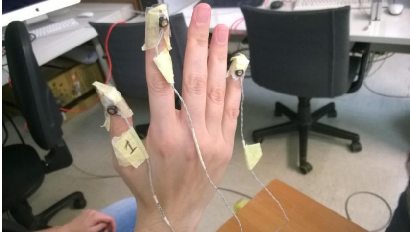
Figura 32 Posizionamento dei marker ottici sulle dita
