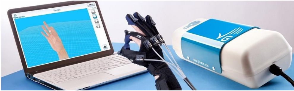
Figura 17 Gloreha e interfaccia grafica mostrata durante l'esercizio
