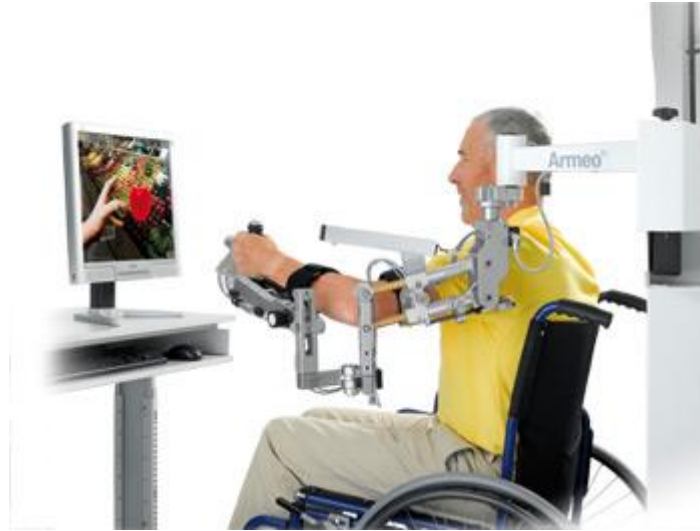
Figura 12 Applicazione del sistema ARMEO con la realtà virtuale
