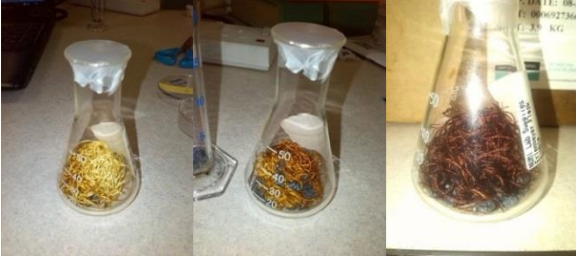
Figura 1. Fibre di seta durante il trattamento ai vapori di iodio. Dopo 3 ore (sinistra), dopo 5 ore (centro), dopo 26 ore (24 ore a 25°C e altre 2 ore a 70°C in un forno) (destra).
