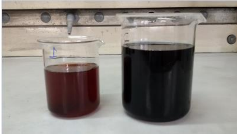
Fig. 16.1 – fotografia del cambiamento di colore del refluo concentrato tal quale della stamperia Seride prima (sinistra) e dopo (destra) la prova OxiTop.
