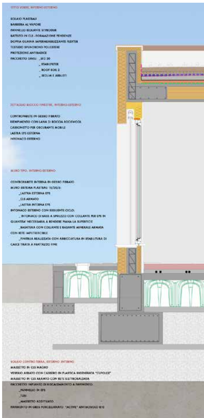
175. SEZIONE COSTRUTTIVA CON STRATIGRAFIA MATERIALI
