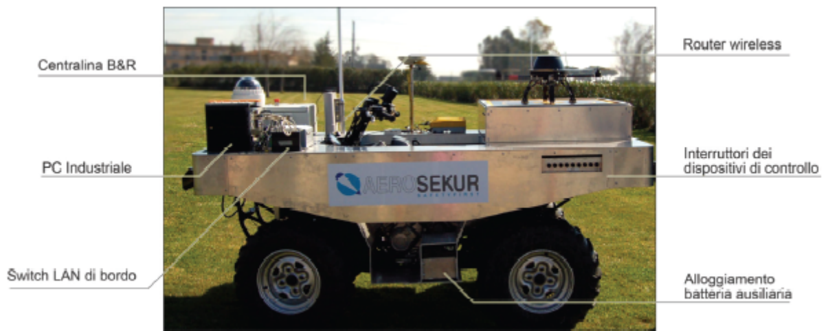
Figura 2.2: Principali componenti dell'ATV considerato
