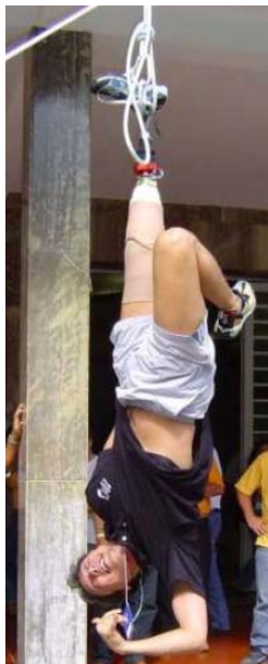
Figura 2.28: prova estrema, effettuata per testare l'efficacia di un sistema vacuum assistito attivamente
