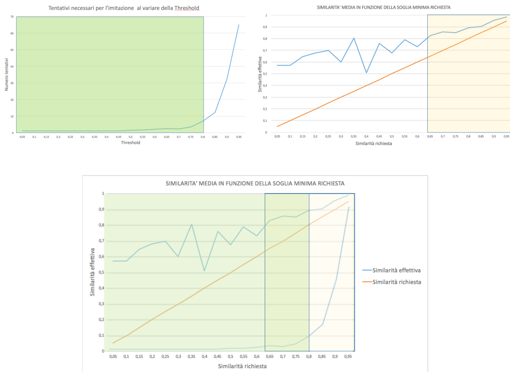
Figura 7.5 - Nel primo grafico in alto a sinistra, che mostra l'andamento del numero di tentativi medio in funzione della threshold richiesta, è stata evidenziata la parte giudicata accettabile dal punto di vista del numero dei cicli e del tempo impiegato dal sistema per giungere ad una soluzione, ossia fino a circa 10 tentativi per parola. Nel grafico in alto a destra, rappresentante il grado di similarità media in funzione della threshold, è stata evidenziata invece la sezione corrispondente ad una similarità che garantisce imitazioni molto
