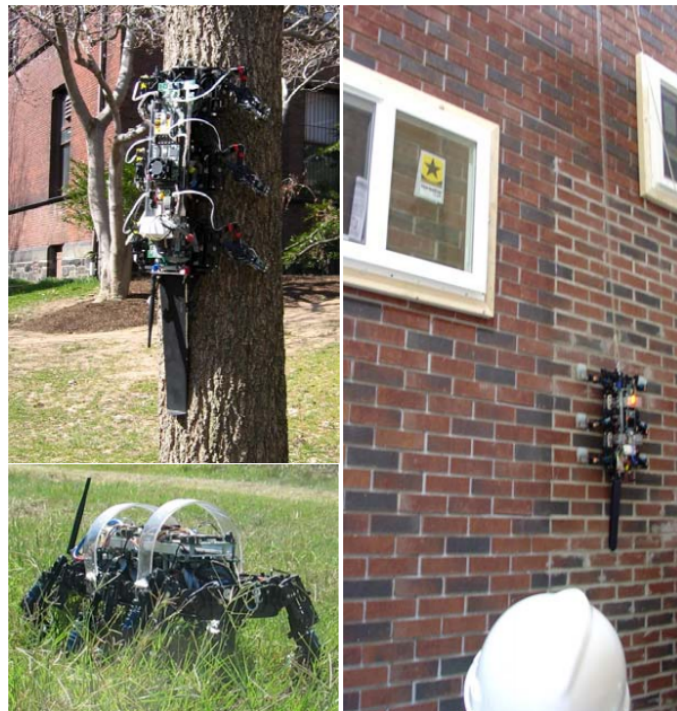
Figura 3.2 - Nella figura è mostrato un robot in grado di arrampicarsi su numerosi tipi di superficie sfruttando gli stessi meccanismi che utilizzano i gechi in natura. Si tratta di un design profondamente bioispirato.
