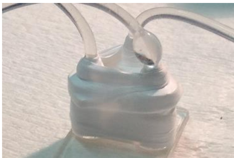
Figura 4.13 - Rigonfiamento tubo siringa laterale relativo alla Prova 4
